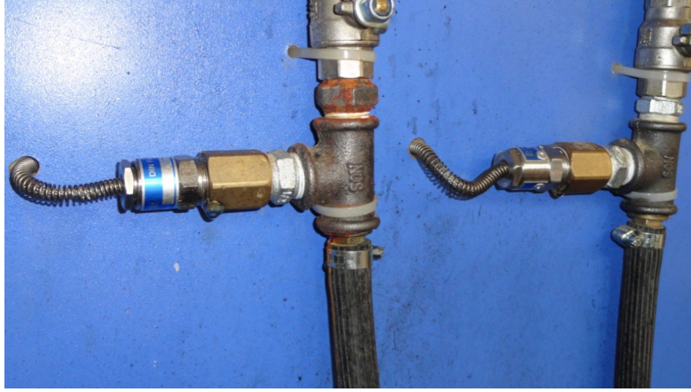
Şekil 5.21 Soğutma suyu giriş ve çıkışlarında konumlandırılmış termokupullar
