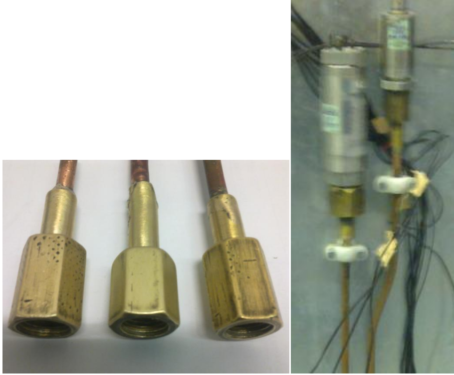
Şekil 3. 5 İlk resim, basınç transdüseri bağlantı aküleri. İkinci resim, akülerin transdüserlere bağlanmış şekli
