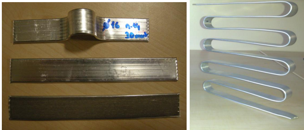
Şekil 3. 46 Sol şekilde; 13 cm uzunluğunda kesilen numuneler, üstten birinci ve ikinci model A, en alttaki numune model B. Sağ şekilde ise kanalları bükülmüş bir model yer almaktadır
