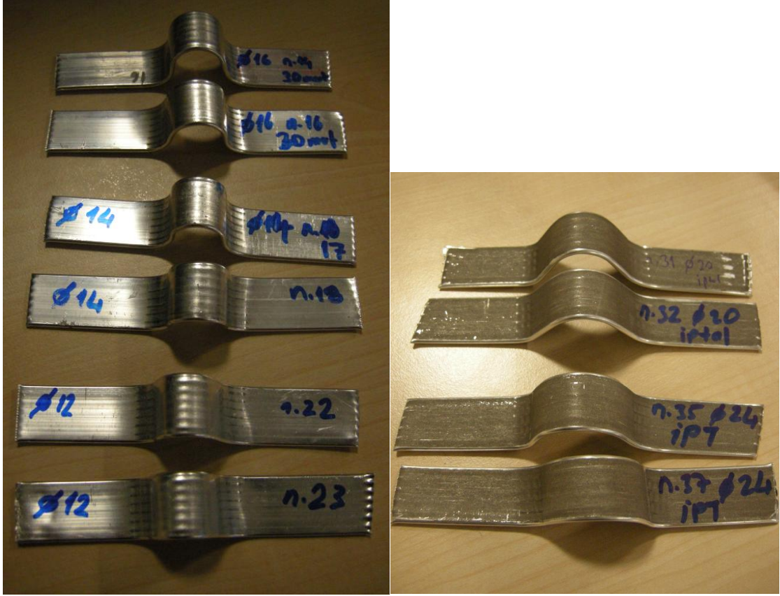
Şekil 3. 48 Model A (sol) ve B (sağ) için sonuçlandırılan numuneler
