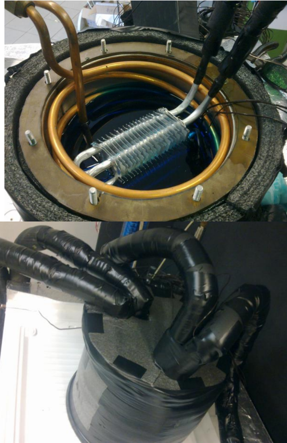
Şekil 3. 10 Buharlaştırıcı haznesi şartlandırma haznesi açık ve kapalı durumu
