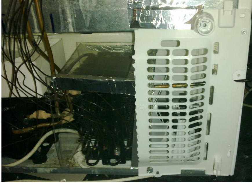
Şekil 3. 30 Deneyler sırasında kullanılan sadece fan tarafını kapatan tasarım (K11)
