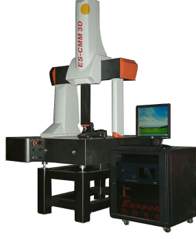
Şekil 7.6 Hareketli köprülü CMM yapısı [3]
