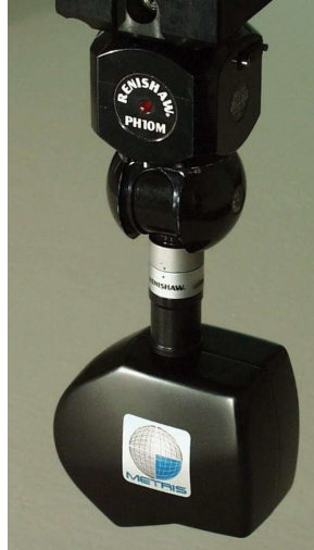
Şekil 7.12 Temassız ölçme işlemlerinde kullanılan lazer tip prob [7]
