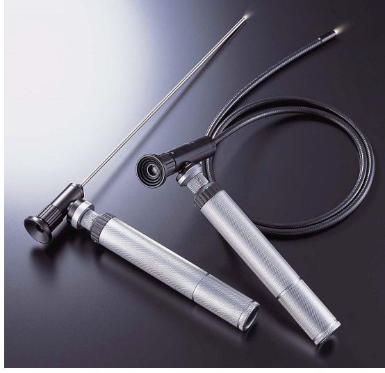
Şekil 7.2 Görsel kontrollerde kullanılan rijit ve esnek endoskoplar [3]
