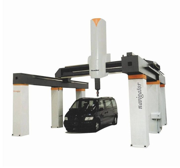
Şekil7.4 Ayaklı köprülü CMM ile bir minibüsün ölçümü [3]
