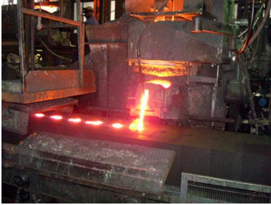
Şekil 3.7 Disamatik kalıplamada döküm işlemi
