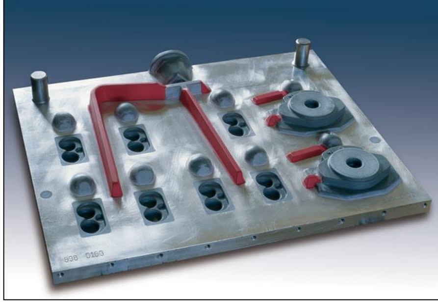
Şekil 3.17 Disamatik model ve plaka örneği [17]
