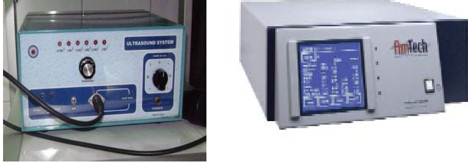
Şekil 2. 8 Çeşitli entegre güç kaynağı örnekleri ve güç ayarlama sistemi [10]
