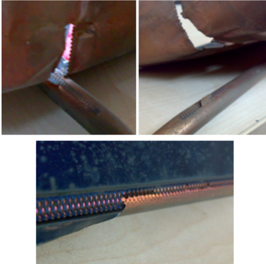
Şekil 4. 13 Kaynak esnasında bakır soğurucunun kesilmesi problemi
