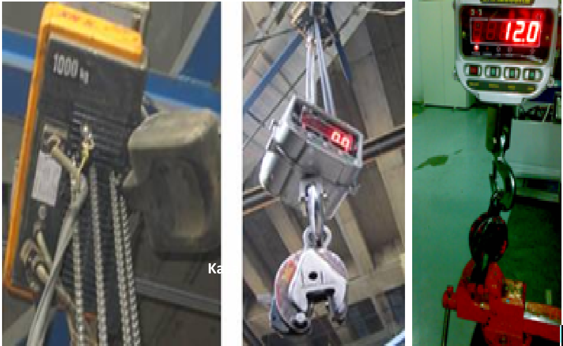
Şekil 5. 11 Çekme kuvvetini üreten kreyn ve test düzeneğinin genel görünümü
