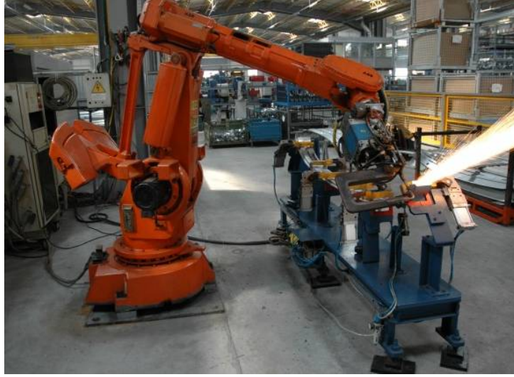
Şekil 1. 2 Kaynak yöntemlerinde otomasyon uygulaması (Tam otomatik MIG)
