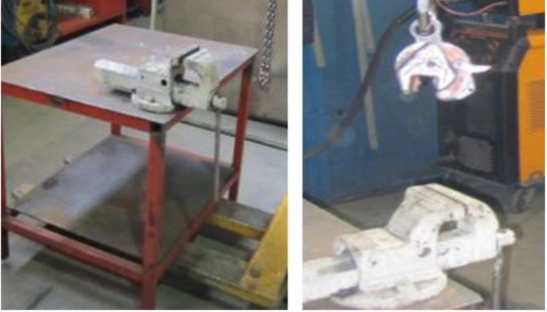
Şekil 5. 10 Sabitleme çenesi, test sehpası ve çekme aparatı
