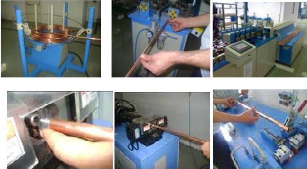
Şekil 3. 14 Filmaşin boy kesim istasyonu, manifold patlatma ve büküm istasyonu
