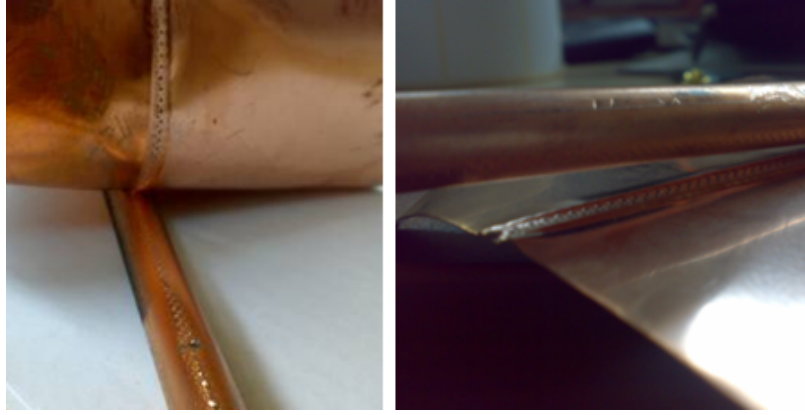
Şekil 4. 14 Kaynak başlangıcında nüfuziyet problemi
