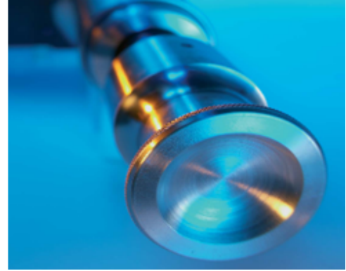
Şekil 2. 22 Sürekli dikiş kaynağı ultrasonik kaynak makinesinde horn ve iş parçası [5]
