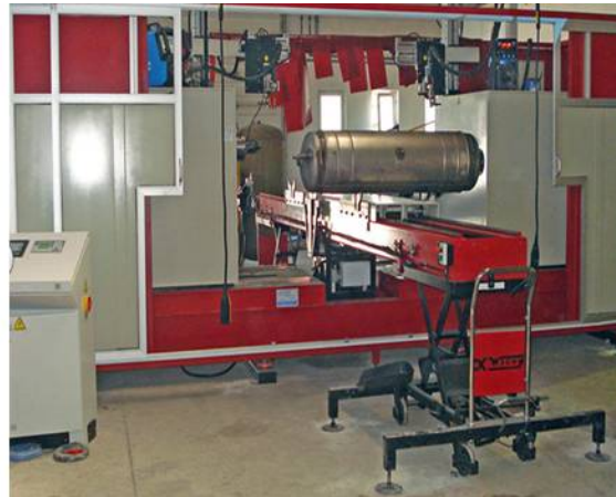
Şekil 1. 3 Boy ve çevre kaynağı otomasyon uygulaması (Yarı otomatik MIG)
