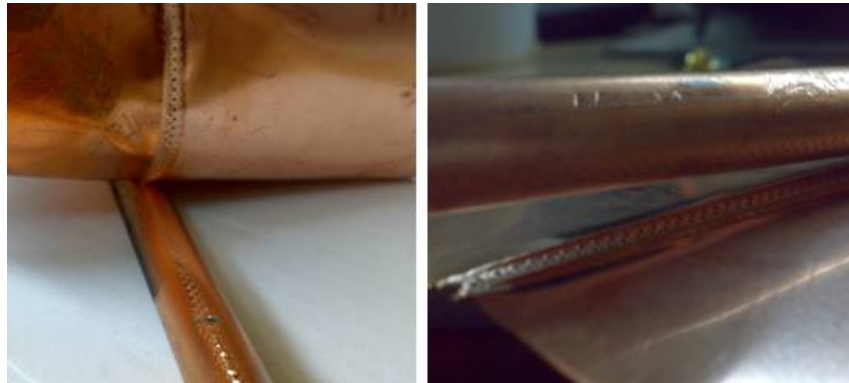
Şekil 4. 12 Ultrasonik kitin yüksek hızla hareketi sonucu birleştirme problemleri
