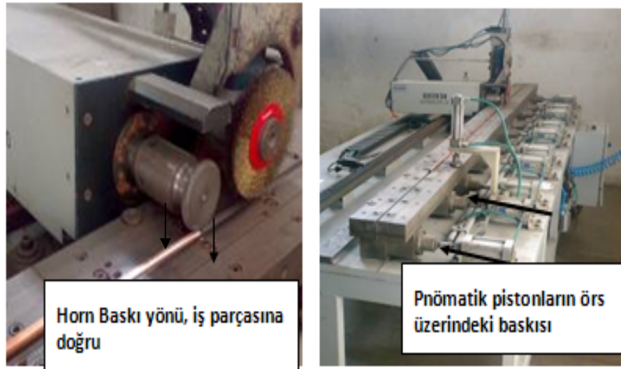
Şekil 2. 55 Sürekli dikiş kaynak makinesinde baskı uygulama yönü
