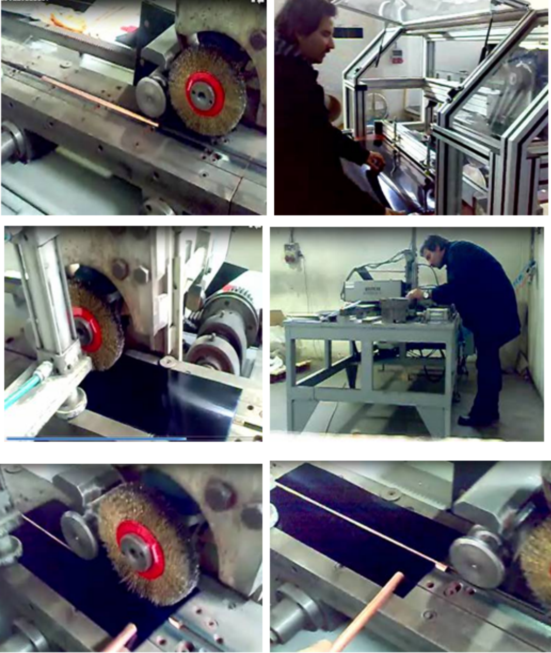
Şekil 5. 5 Kaynak öncesi boruların temizlenmesi, kaynak işlemi
