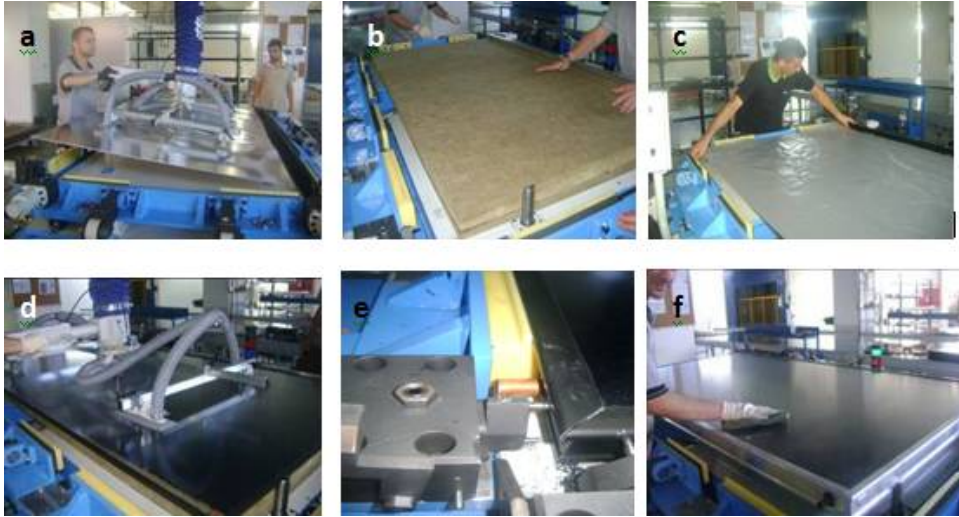
Şekil 3. 21 Güneş kolektörü montaj operasyonları
