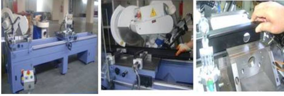
Şekil 3. 20 Alüminyum profil boy kesim ve punch istasyonu
