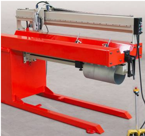
Şekil 1. 3 Boy ve çevre kaynağı otomasyon uygulaması (Yarı otomatik MIG)
