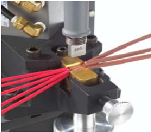
Şekil 2. 27 Birleşik yapılı horn ile yapılmış operasyon örneği [10]
