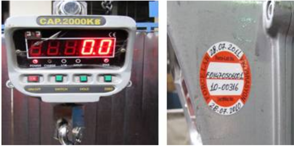
Şekil 5. 9 Dijital dinamometre ve kalibrasyon etiketi
