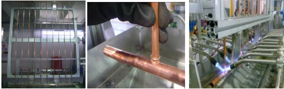
Şekil 3. 15 Dolaşım borusu uç şişirme ve gümüş halka montajı
