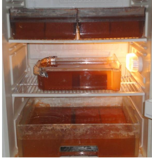
Şekil 2. 12 Tuğlaların buzdolabında su içerisinde bekletilmesi
