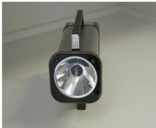
Şekil 3. 5 Motor devrinin belirlenmesinde kullanılan stroboskopun gösterilişi
