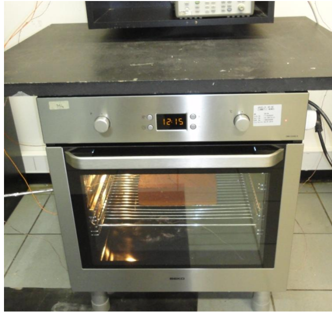
Şekil 2. 2 Isıtılan hacimle birlikte enerji tüketim deney düzeneğinin görünüşü
