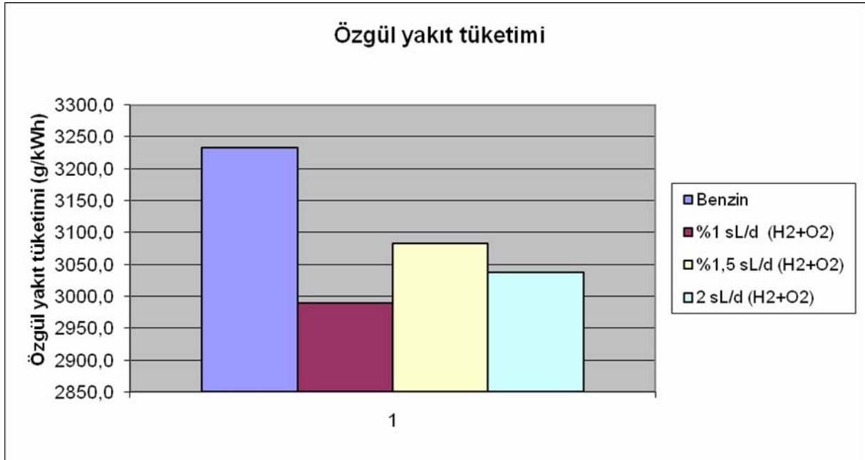
Şekil 6.10 Güç kaynađı kullanılarak rölantide özgöl yakıt tüketimi grafiđi
