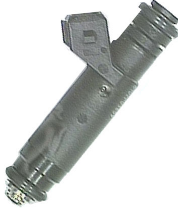
Şekil 4.3 Siemens Deka Benzine enjektörü
