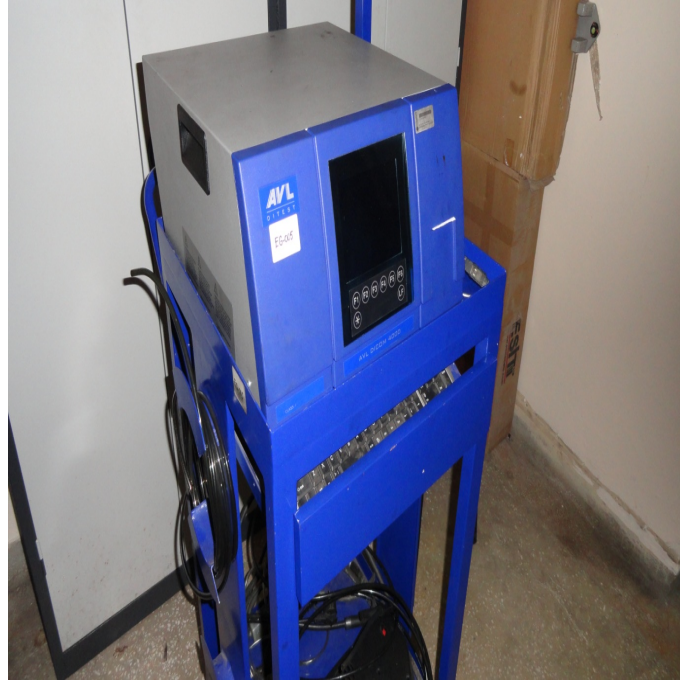
Şekil 4.15 AVL DICOM 4000 gaz analiz cihazı
