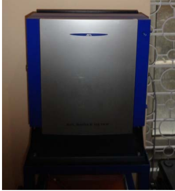
Şekil 4.16 AVL 415 S filtre tipi is ölçüm cihazı
