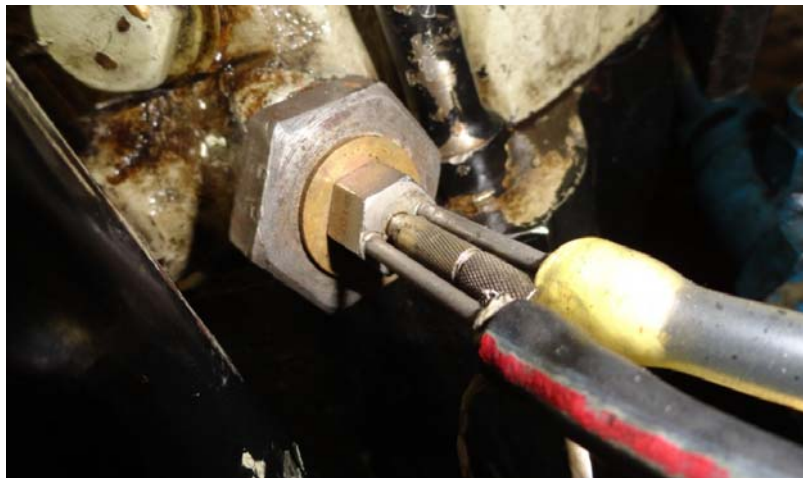
Şekil 4.10 AVL marka piezoelektrik basınç sensörü
