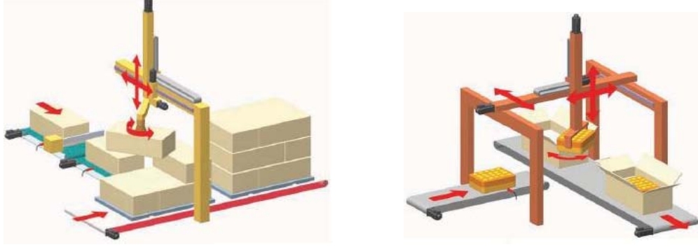
Şekil 1.2 Kartezyen robot örnekleri
