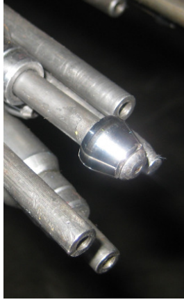
Şekil 8.4 Dikey şişirme makinesinde kullanılan örnek bir mil
