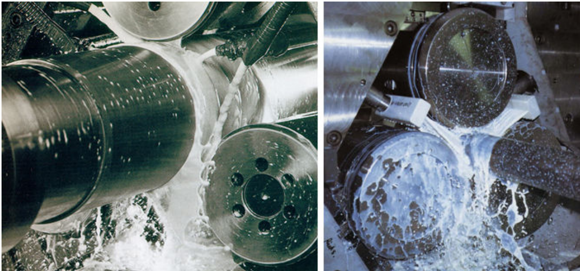
Şekil 3.18 Cidar ezmeli sıvama tezgâhlarında, parça soğutma sistemi (Pmf [8]).
