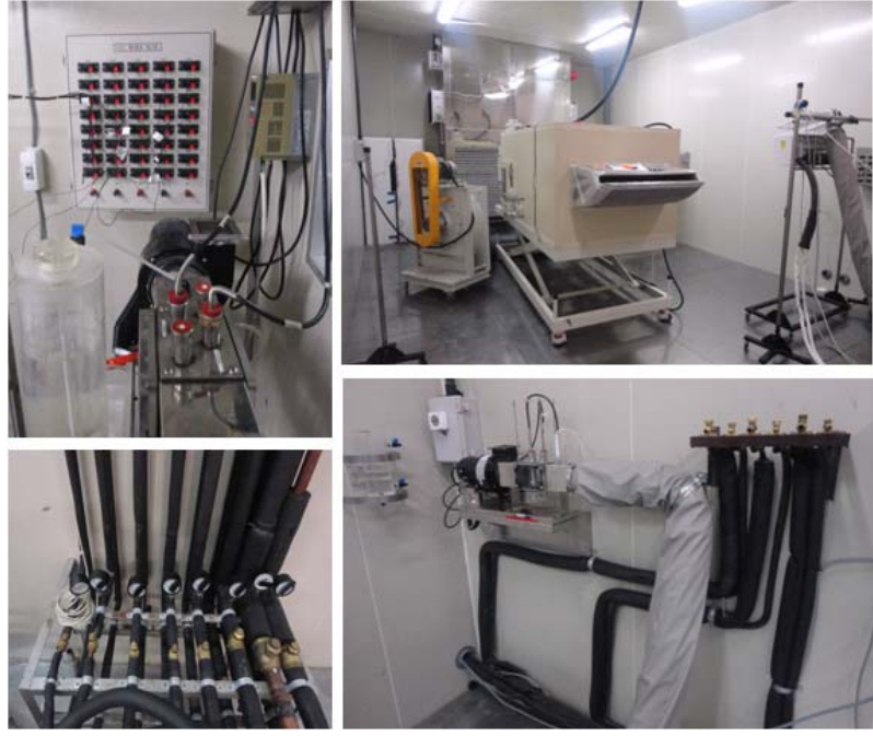
Şekil 4. 9 Datalogger, ısıtma ve oda sıcaklık ölçüm devresi ve iç ünite kapasite ölçüm kabini
