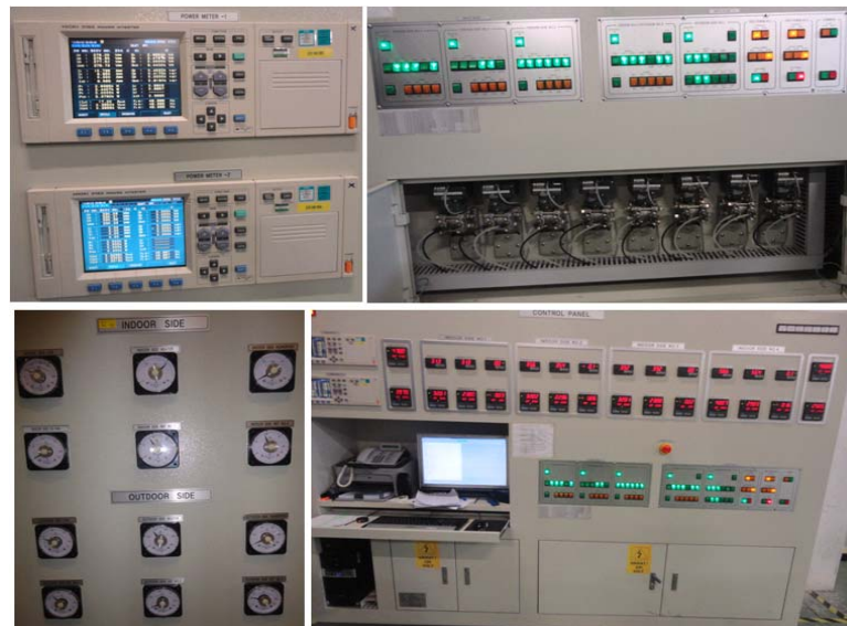
Şekil 4. 8 Kalorimetrik test odasının kontrol edildiği ve verilerin toplandığı sistem
