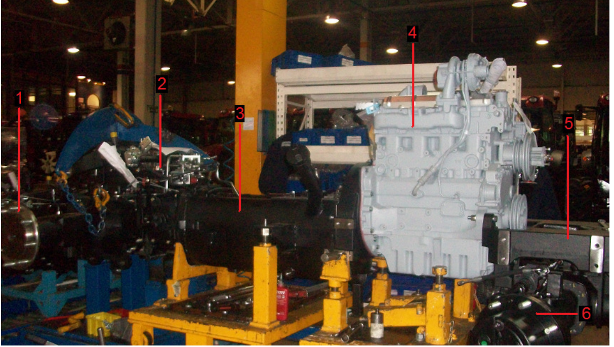
Şekil 3.1 Traktörün ana parçaları; 1) Arka Aks, 2) Lift Kaldırıcı, 3) Yakıt Tankı, 4) Motor, 5) Ön Dingil Mesnedi, 6) Ön Aks
