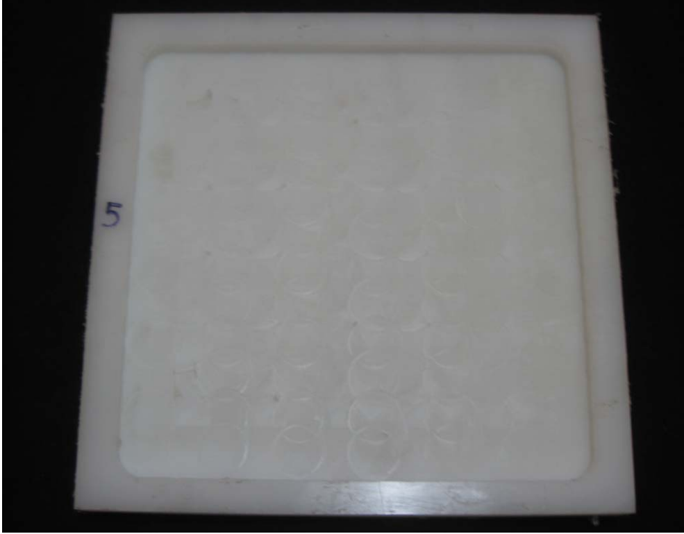
Şekil 7.29 Dalarak Kaba İşleme ve Trokoidal İşleme Kombinasyonu – 3 örneği.
