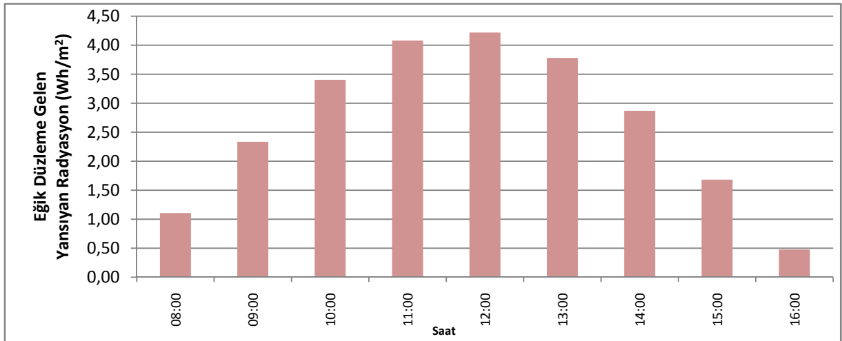
Şekil 8.4: Algoritmada kullanılan eğik düzlem yansıyan radyasyon modeli için hesaplanan eğik düzleme gelen yansıyan radyasyon değerleri (Ocak)
