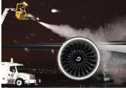
Şekil 1.3 Uçak yerdeyken buz giderme yöntemi
