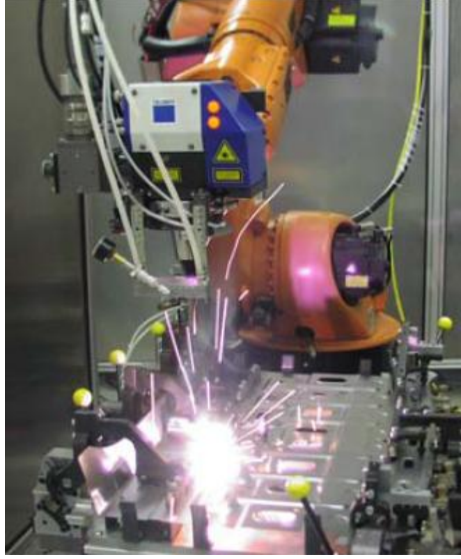
Şekil 6.10 Robot koluna monte edilen tarayıcı ünite ile kaynak[15]
