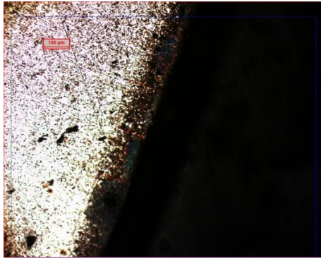
Şekil 5.20 S6N3 kodlu numunenin ITAB görüntüsü ve yüzey sertlik değişim grafiği
