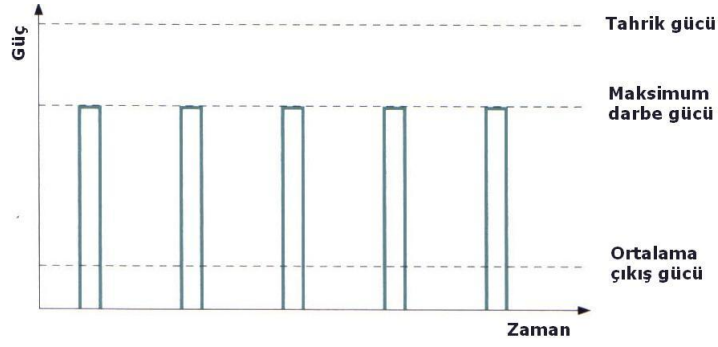
Şekil 3.16 Darbeli katı hal laserlarında güç – zaman grafiği
