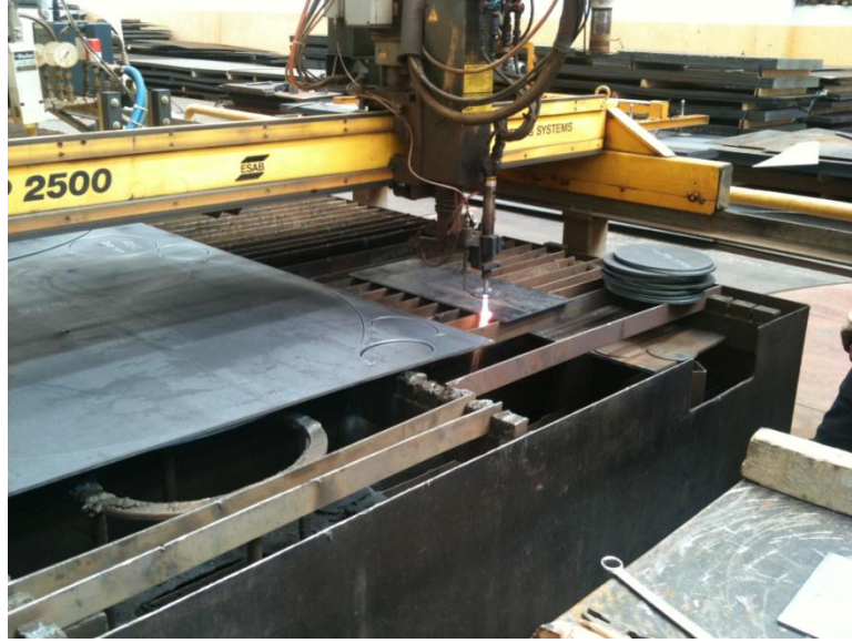
Şekil 5.2 Esab Ultrarex Uxd-p 2500 plazma kesme tezgahının görünümü
