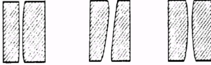
Şekil 3.13. Polarizasyon şeklinin yarık profiline etkisi. (Polarizasyon yönüne 0^\circ , 45^\circ ve 90^\circ açıyla; malzeme: St34; 1 kW CO 2 )
