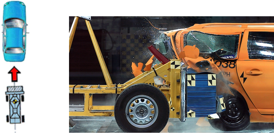
Şekil 4.19 Arkadan çarpışma testi.
