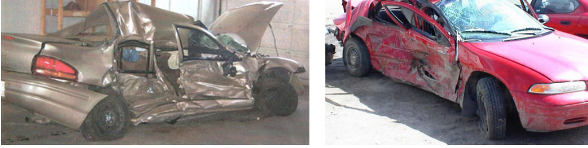
Şekil 4.18 Yandan çarpışma sonucu oluşan hasar örnekleri.
