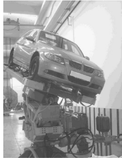
Şekil 5.3 Araçların eylemsizlik momentini ölçmekte kullanılan çeşitli test cihazları. (Bracati, R. ve Risso, R., 2009)
