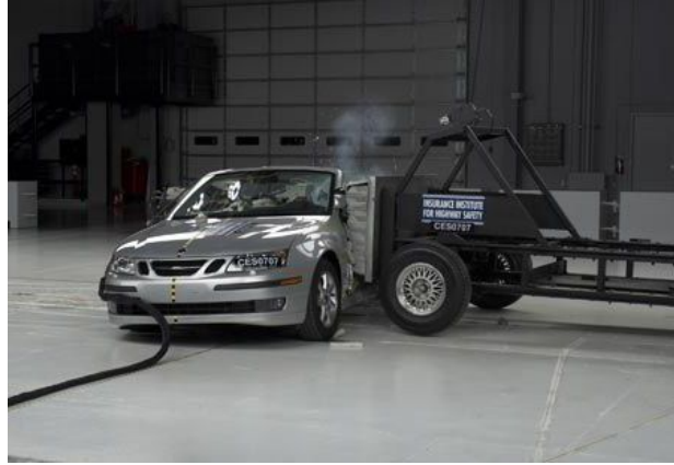
Şekil 4.17 Yandan çarpışma testi.
