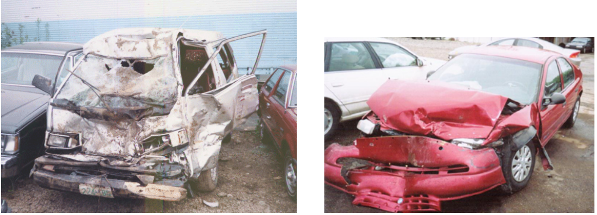
Şekil 4.7 Önden çarpışma sonucu oluşan hasar örnekleri.
