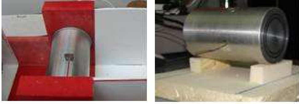
Şekil 3.17 Doğal taşınım deneylerinde alüminyum çubuğun sistemde ve ortamda konumlandırılma şekilleri
