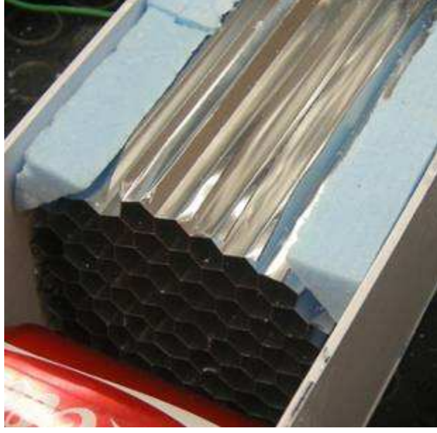
Şekil 3.4 Kanal içerisine yerleştirilen petek yapıdaki akım düzleştirici
