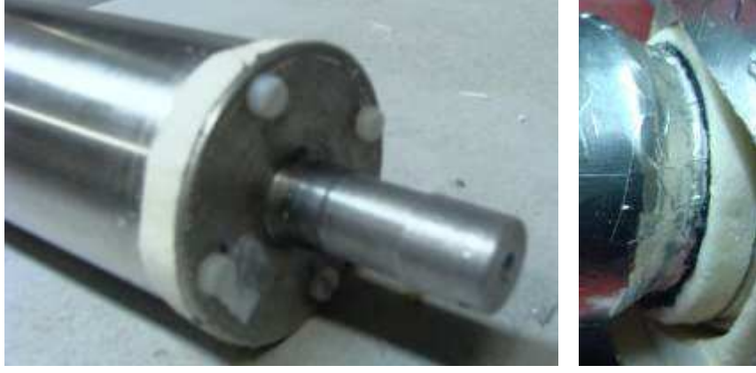
Şekil 3.8 Alüminyum çubuk ve sıvı kabının sisteme bağlanma şekilleri
