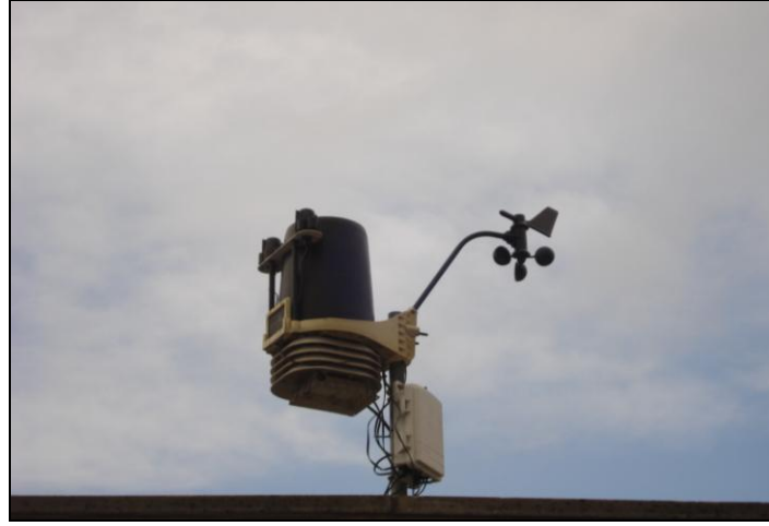
Şekil 5.5 ENKA binası üzerindeki anemometre
