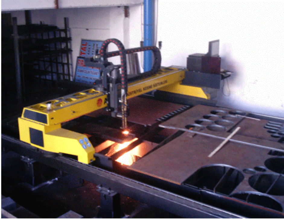
Fotoğraf 6.1 Oksi-asetilen kaynak yöntemi ile CNC kesme
