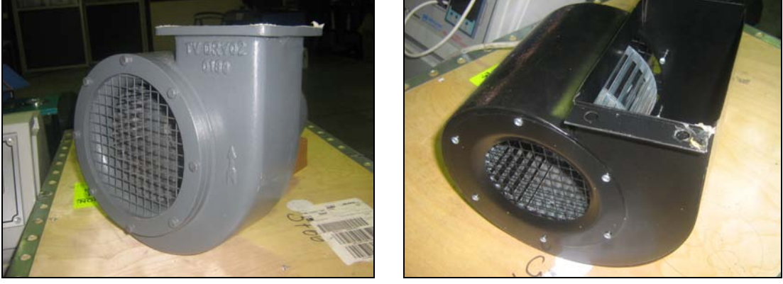
Şekil 5.8 Rezistanslı (solda) ve radyant ısıtıcıda (sağda) kullanılan soğutma fanları
