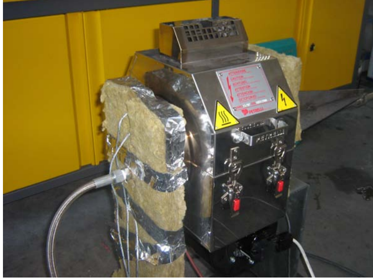
Şekil 5.15 Silindirin üzerine monte edilmiş radyant ısıtıcı
