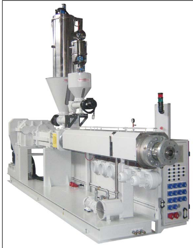
Şekil 3.10 110/25D zıt dönüşlü paralel çift vidalı bir ekstrüder
