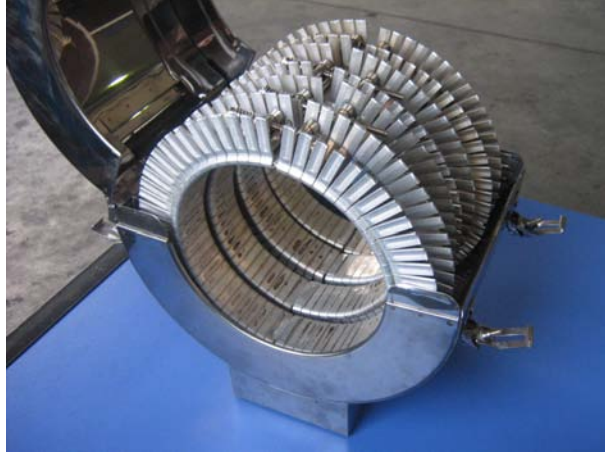
Şekil 5.5 Düzenekte kullanılan seramik yalıtımlı rezistanslı ısıtıcı
