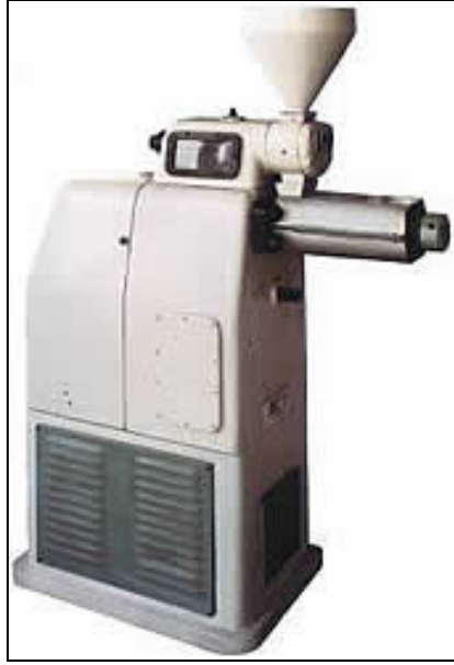
Şekil 3.2 1938 yılında üretilen ilk eş dönüşlü çift vidalı ekstrüder
