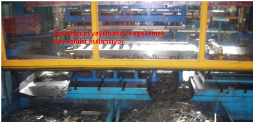
Şekil 4.2 350 Ton gürültü kontrol uygulaması
