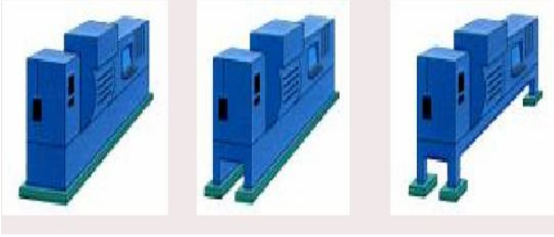
Şekil 2.7 Ekipmanların ayakları temelin içine gömülmesi ile ilgi uygulama
