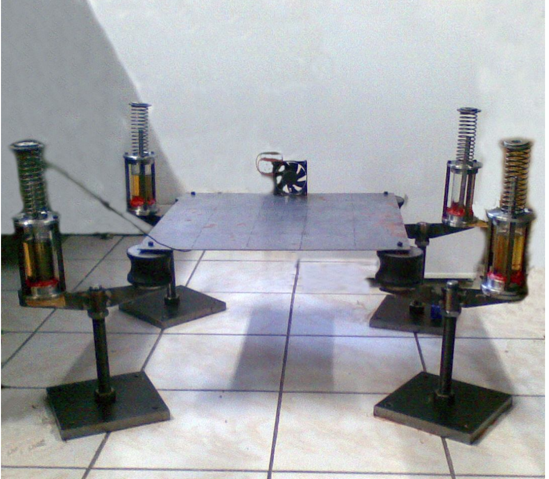
Şekil 11.1 Histeretik Sönümlleme Sistemi Deney Düzeneği
