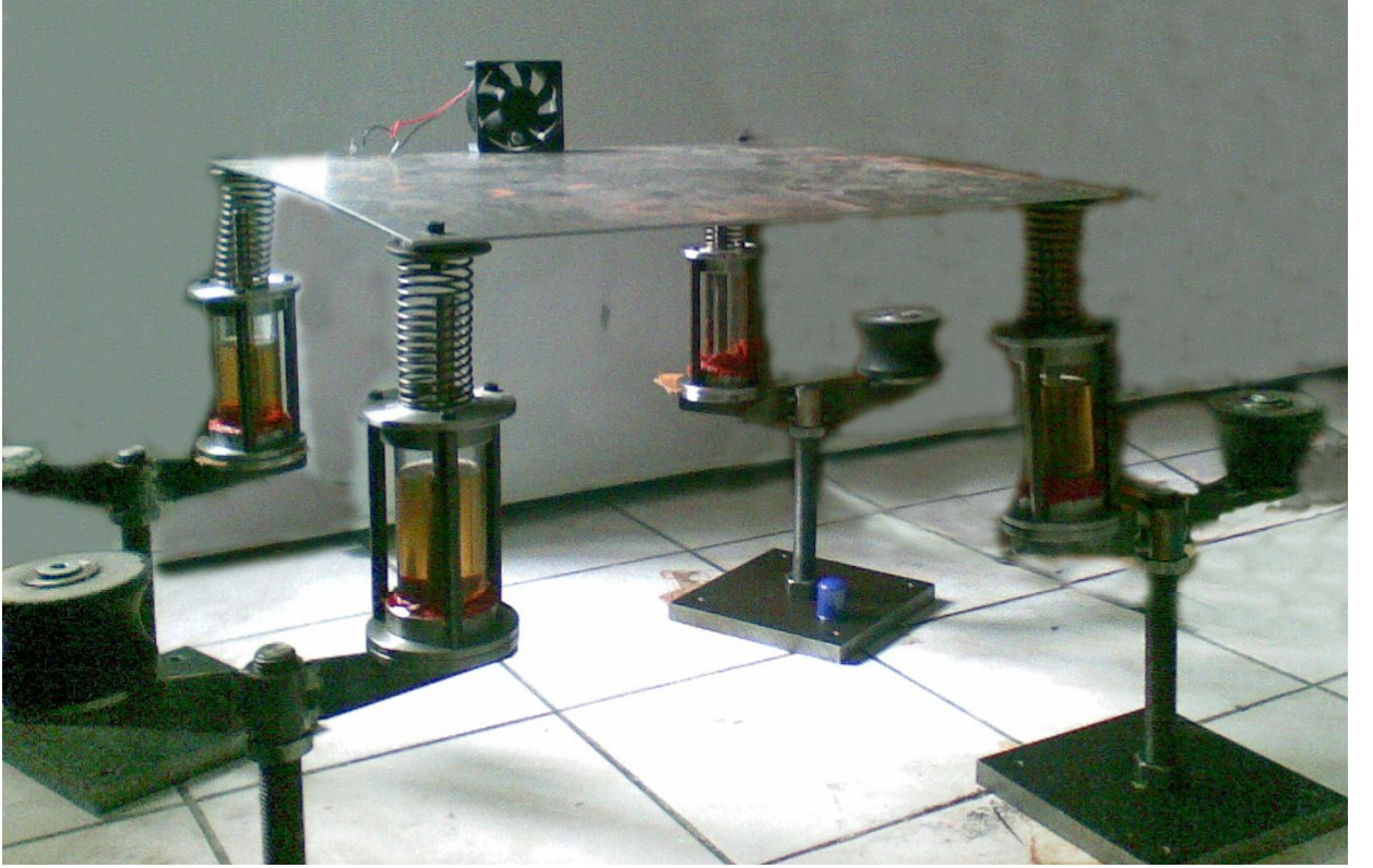
Şekil 10.1 Viskoelastik Mesnetli Sistem Deney Düzeneği
