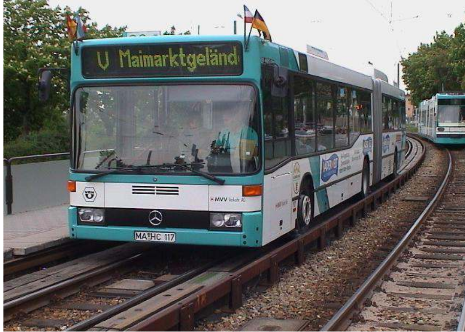
Şekil 5.6: Mannheim (Almanya) Ray Üstü Yerleştirilmiş Mekanik Yönlendiricili Sistem
