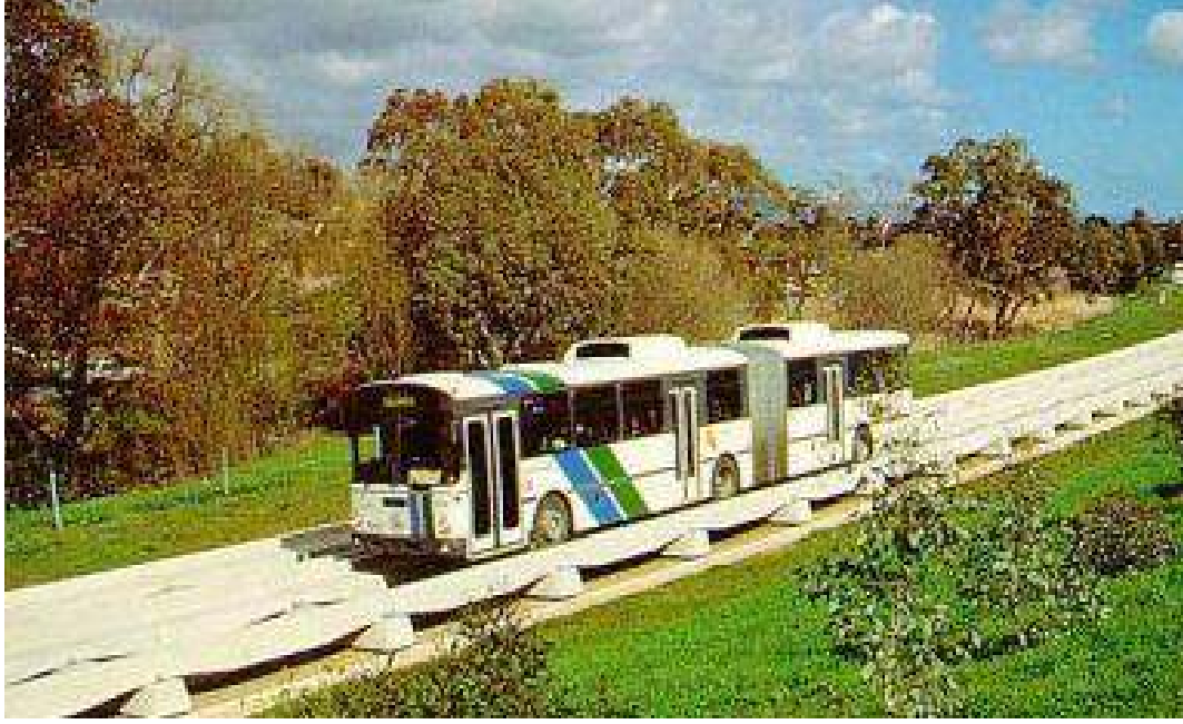
Şekil 5.5: a),b) O-Bahn, Adelaide (Avustralya) Mekanik Yönlendiricili Sistem
