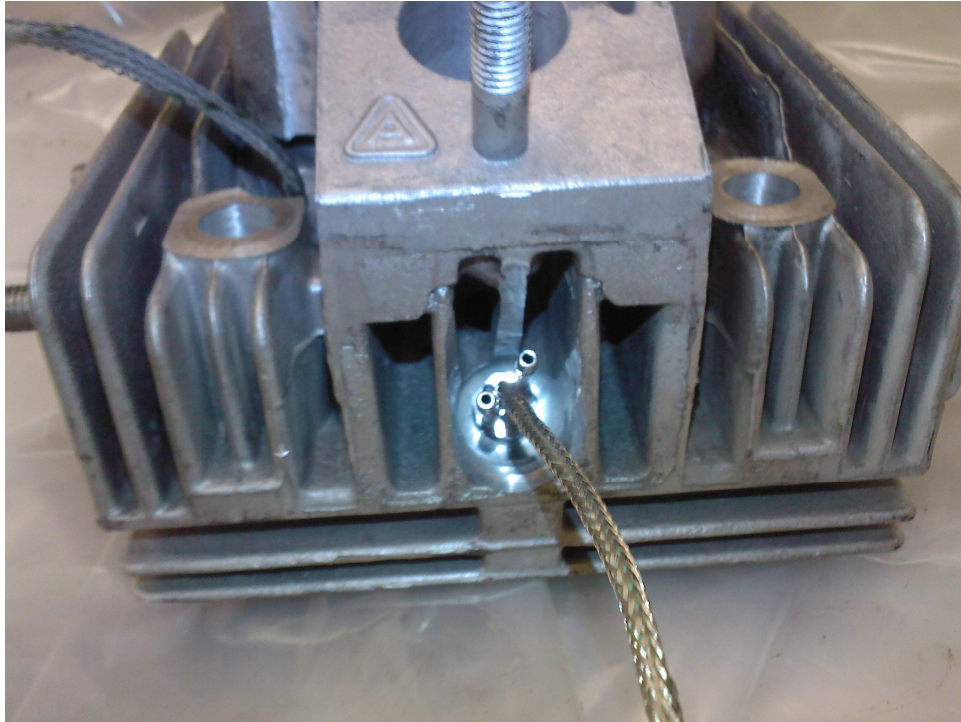
Şekil 4.4 Silindir içi basınç sensörünün ve termokaplın montajı
