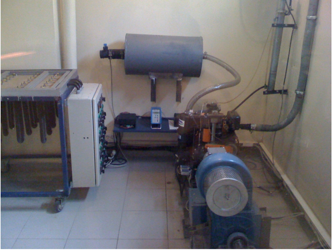
Şekil 4.2 Dizel motor test düzeneği
