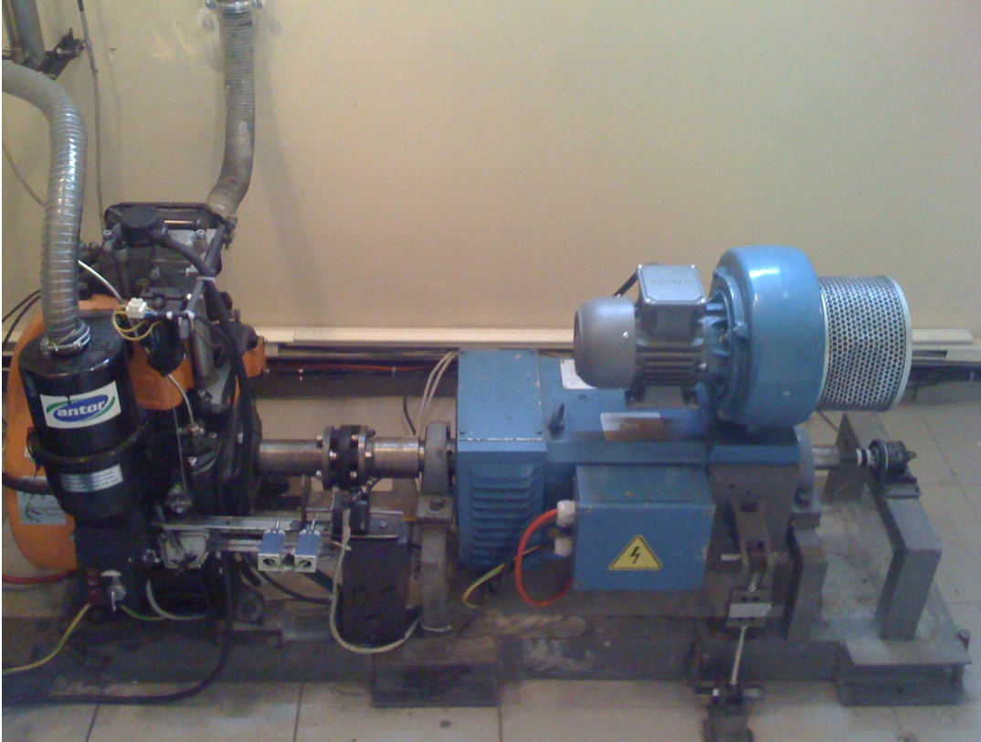
Şekil 4.5 Dizel motor ve DC motor bağlantısı
