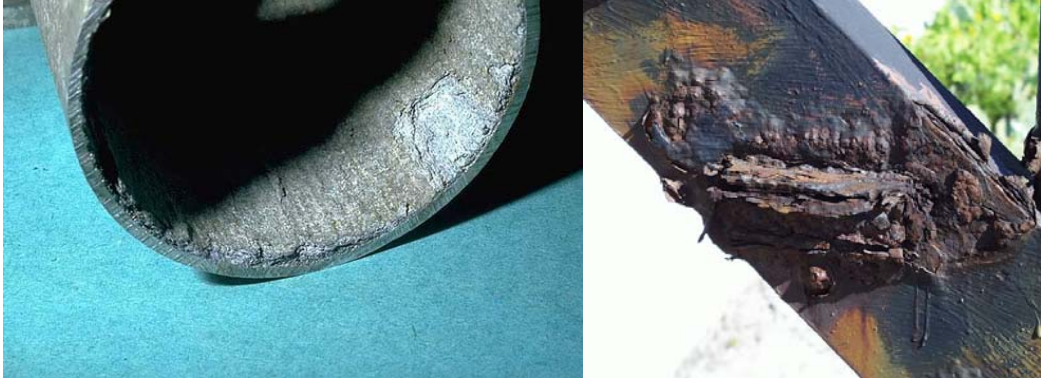
Şekil 2.9 Taneler arası korozyon [1]
