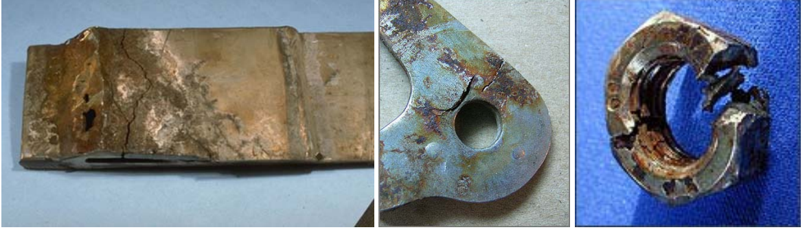
Şekil 2.17 Stres korozyon çatlaması [5]
