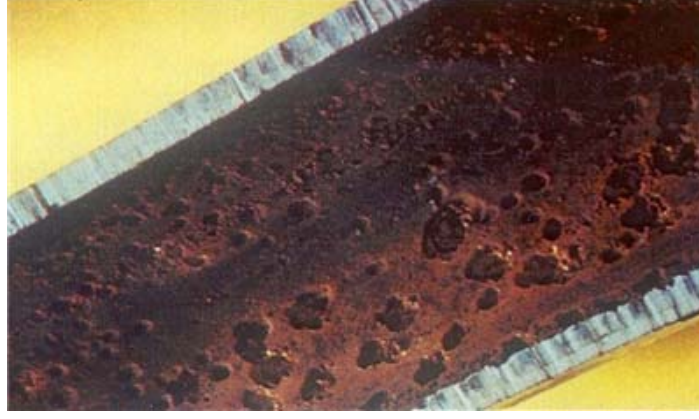
Şekil 4.7 Kazan borusu oksijen kazıntısı
