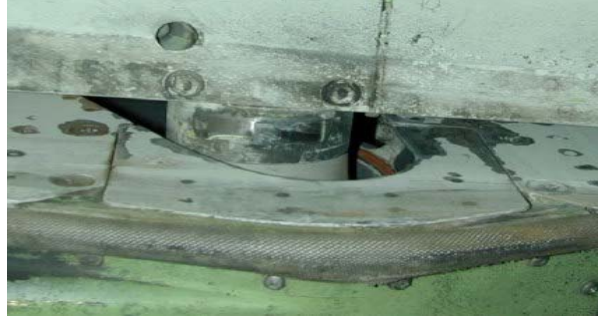
Şekil 2.16 Uçak parçasında kazımalı korozyon [7]
