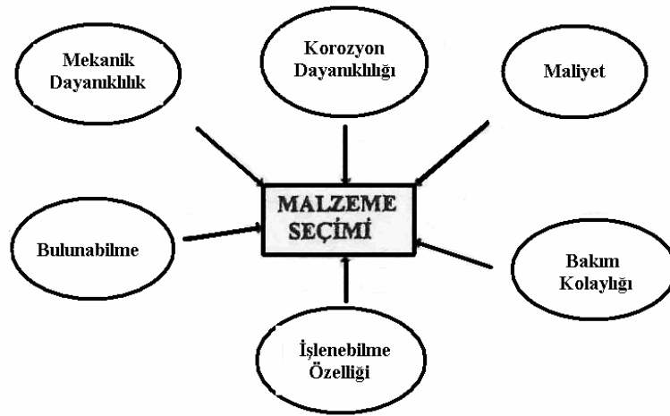
Şekil 1.1 Malzeme seçimine etki yapan faktörler (Yalçın ve Koç, 1997)
