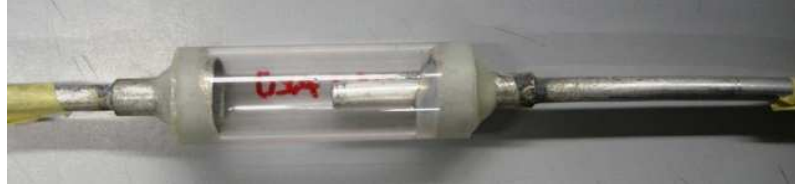
Şekil 3.8 Hazırlanan ayrıştırıcı prototipi
