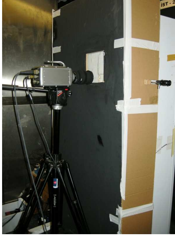
Şekil 3.11 Damlacık analizi için kurulan hızlı kamera sistemi
