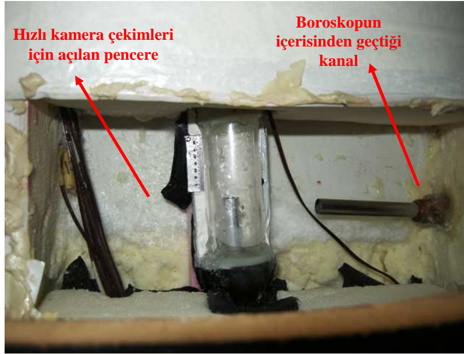
Şekil 3.9 Montajı gerçekleştirilen ayrıştırıcı prototipi
