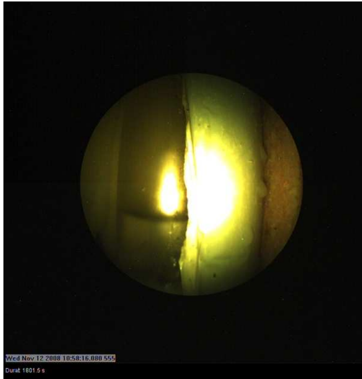
Şekil 4.3 Ayrıştırıcıda depolanan sıvı soğutucu akışkan miktarının boroskop ile ölçümü
