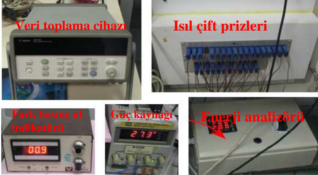
Şekil 3. 13: Ölçüm sisteminde yer alan elemanlar
