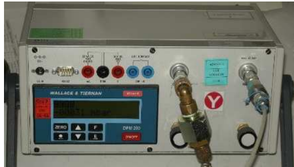
Şekil 3. 29: Transduserlerin kalibrasyonunda kullanılan kalibratör
