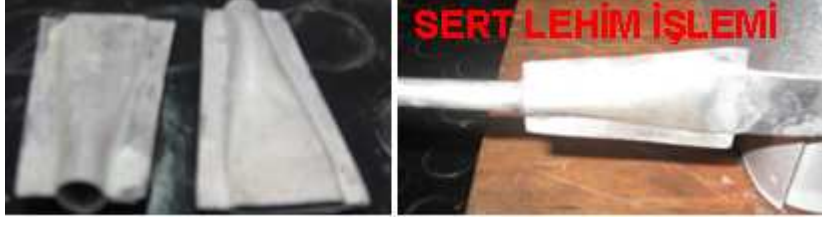
Şekil 3. 4: Sert lehimleme işlemi ile birleştirme işlemi
