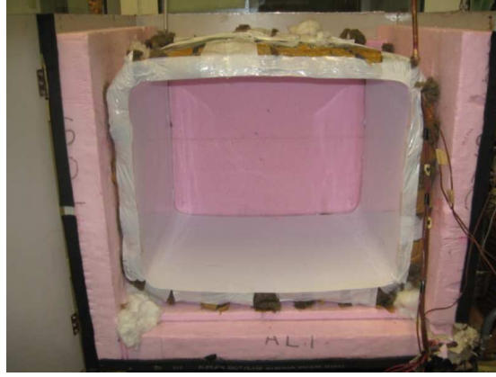
Şekil 3. 17: Buharlaştırıcının bölmeye yerleştirilmesi
