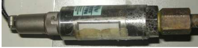
Şekil 3. 21: Kulite marka basınç transduseri
