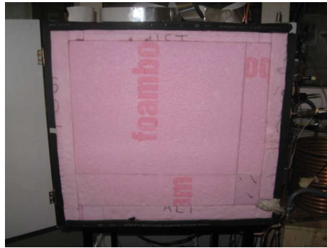
Şekil 3. 20: Kabinin yalıtımlı son hali
