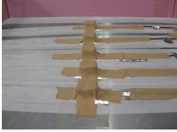
Şekil 3. 16: Minikanallı buharlaştırıcı paslarına termokupl bağlanması
