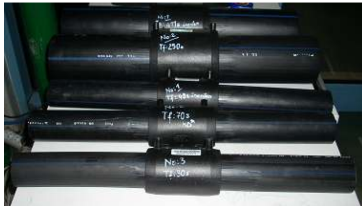
Şekil 7.3 Kaynak işlemleri tamamlanmış ve beklemeye alınan birinci ve üçüncü grup numuneler
