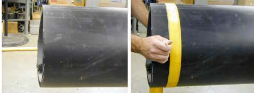
Şekil 3.4 Boru ucunun düzgün kesilmesi için kullanılan aparatlar
