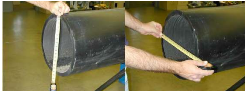
Şekil 3.6 Boru ovalliğinin ölçülmesi
