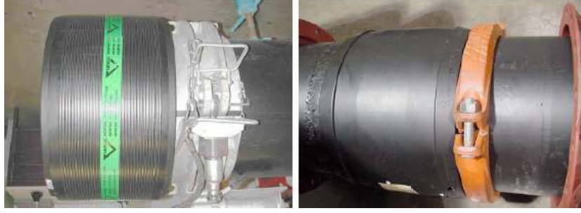
řekil 3.7 Oval boruların yuvarlatılmasında kullanılan aparatlar
