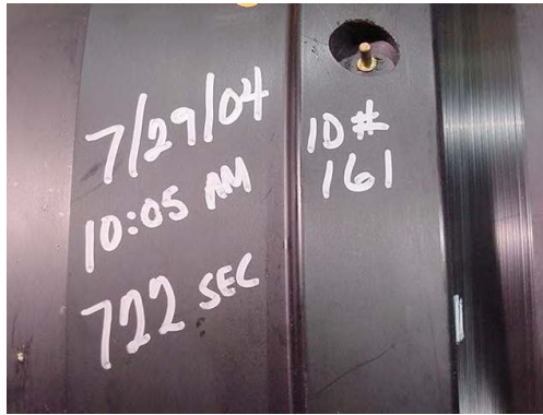
Şekil 3.12 Manşon üzerine kaynak bilgilerinin yazılışı
