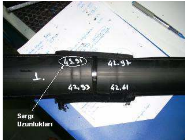
Şekil 7.6 Deney öncesi ilk ve son sargı arası uzunlukların kaydedilmesi
