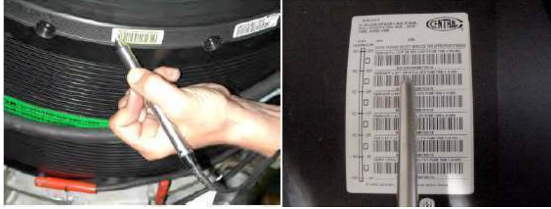
Şekil 3.11 Manşon üzerinde kaynak bilgileri bulunan barkod etiketi ve barkod okuyucu
