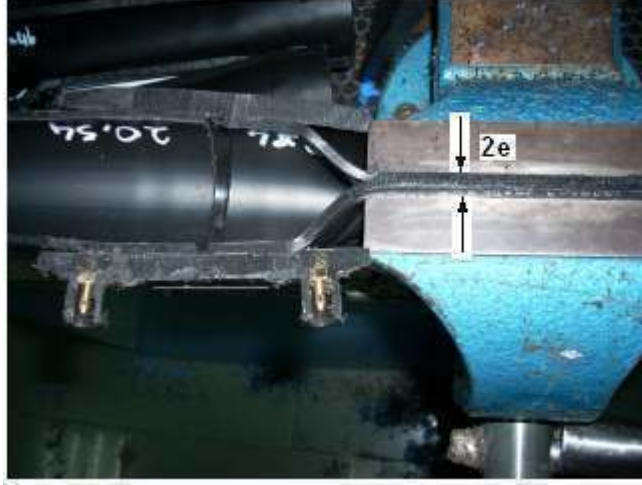
Şekil 7.7 Test parçasının iki et kalınlığına kadar sıkıştırılması
