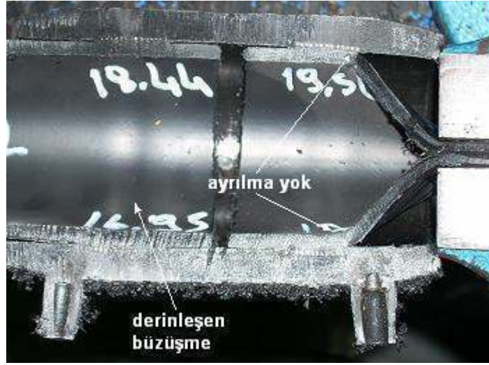
Şekil 7.12 CD122 (Ø63, 40V, Tf:50s) nolu test parçası ayrılma yok
