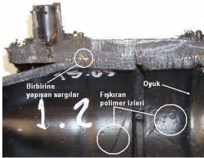
Şekil 7.13 CD112 (Ø63, 40V, Tf:70s) nolu test parçasında aşırı ısınma belirtileri
