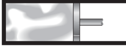
Şekil 3.1 Bir gazın sanki-dengeli genişletilmesi ve sıkıştırılması. (Çengel, 1996 )
