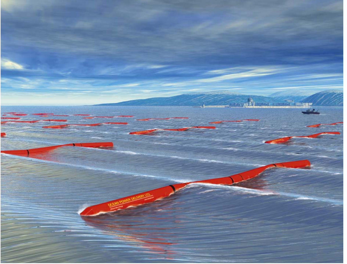
Şekil 3.23 Pelamis enerji dönüşüm çiftliği simülasyonu
