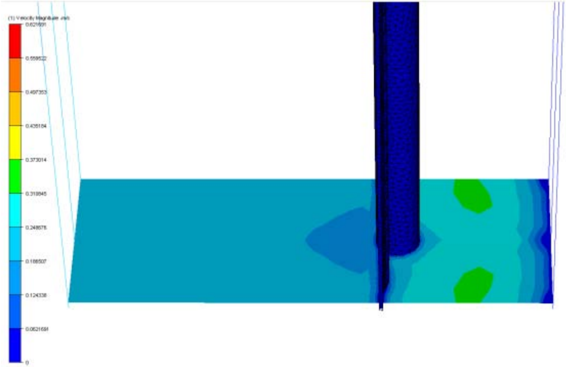
Şekil Ek 2.6 1,25 mm Panjur aralıklı radyatör modeline ait 482 mm'deki hava hız kontuarları
