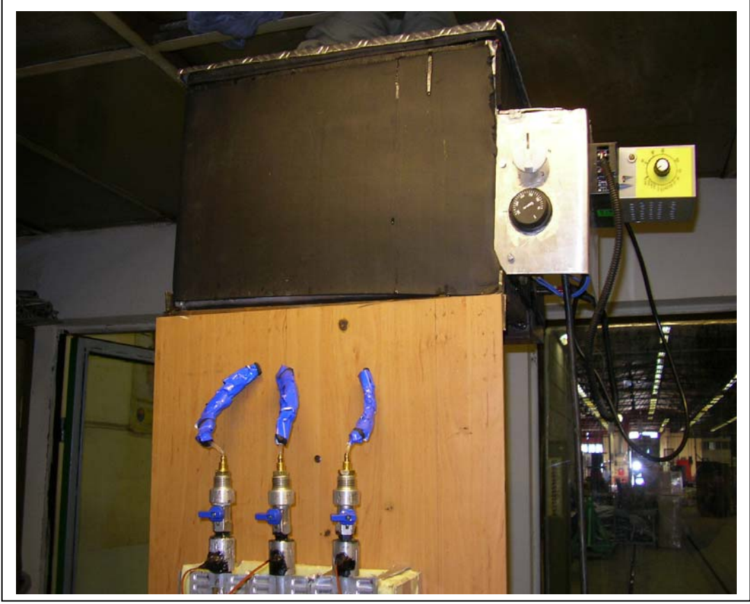
Şekil 4.1 (b) Deney sistemi ısıtıcılı ve termostatlı su haznesi fotoğrafı
