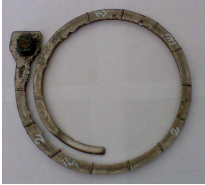
Şekil 6.2 %2 Cr, %2 Ni ilaveli alaşımsız AISI 1040 çeliğinin spiral kalıpta dökülmüş hali Döküm sıcaklığı: 1600°C, Akıcılık: 92 cm
