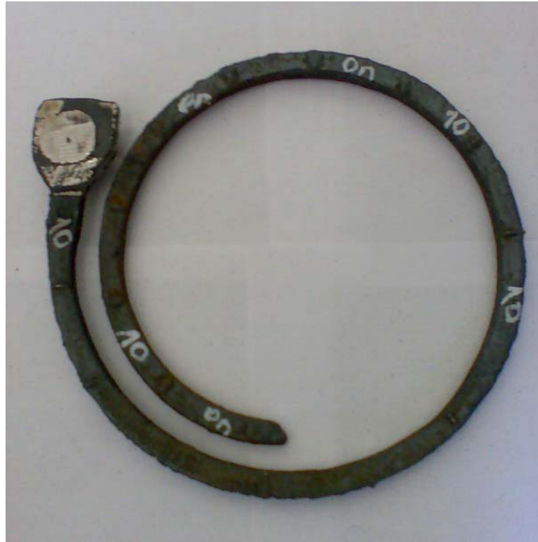
Şekil 6.10 %9 Ni ilaveli alaşımsız AISI 1040 çeliğinin spiral kalıpta dökülmüş hali Döküm sıcaklığı: 1600°C, Akıcılık: 92 cm
