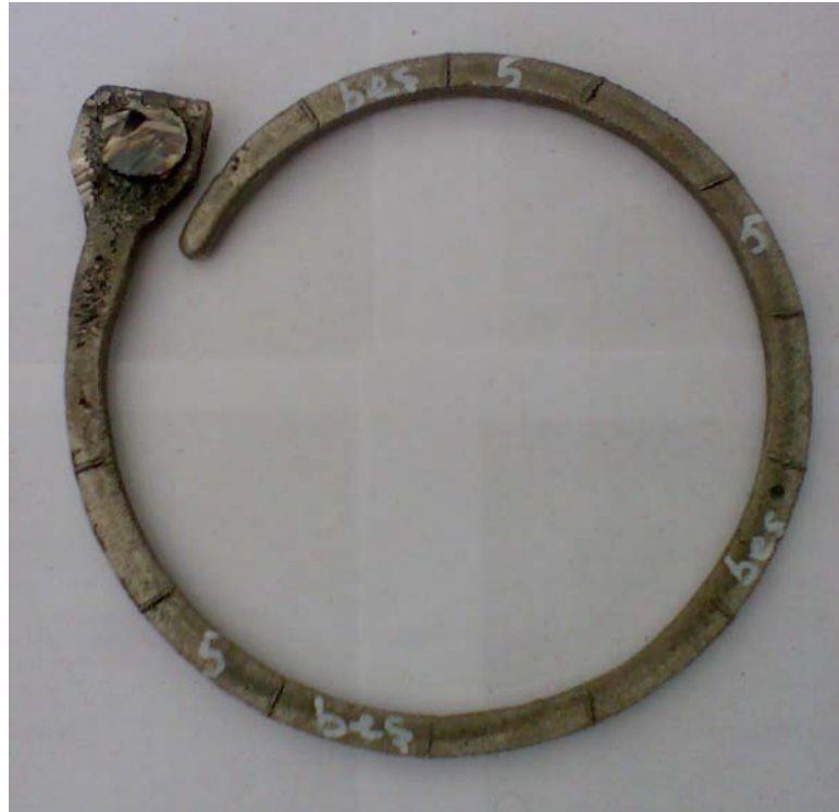
Şekil 6.5 %2 Cr ilaveli alaşımsız AISI 1040 çeliğinin spiral kalıpta dökülmüş hali Döküm sıcaklığı: 1600°C, Akıcılık: 75 cm
