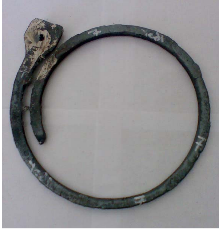
Şekil 6.7 %9 Cr ilaveli alaşımsız AISI 1040 çeliğinin spiral kalıpta dökülmüş hali Döküm sıcaklığı: 1600°C, Akıcılık: 85 cm
