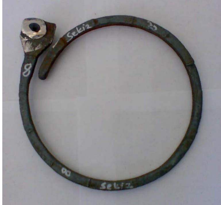
Şekil 6.8 %2 Ni ilaveli alaşımsız AISI 1040 çeliğinin spiral kalıpta dökülmüş hali Döküm sıcaklığı: 1600°C, Akıcılık: 77 cm
