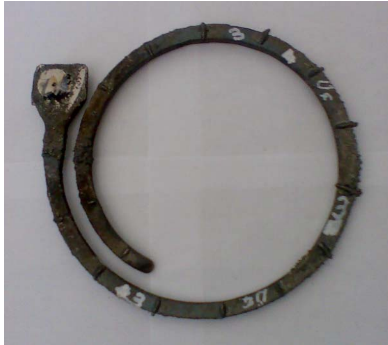
Şekil 6.3 %5 Cr, %5 Ni ilaveli alaşımsız AISI 1040 çeliğinin spiral kalıpta dökülmüş hali Döküm sıcaklığı: 1600°C, Akıcılık: 88 cm
