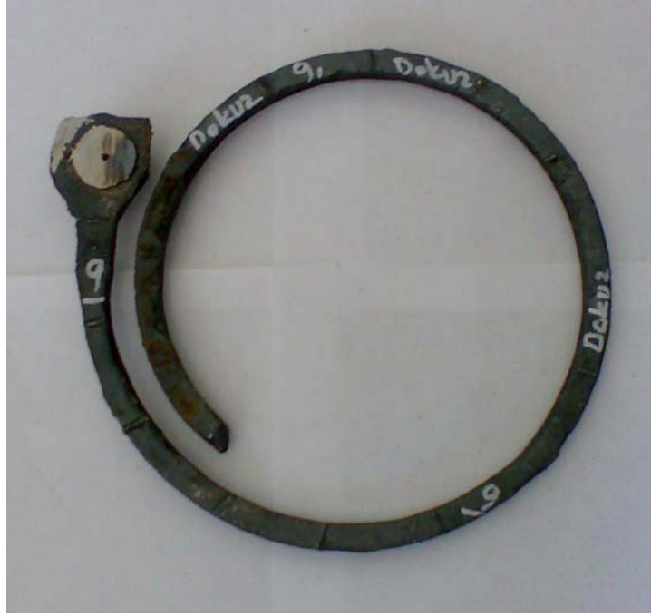
Şekil 6.9 %5 Ni ilaveli alaşımsız AISI 1040 çeliğinin spiral kalıpta dökülmüş hali Döküm sıcaklığı: 1600°C, Akıcılık: 86 cm
