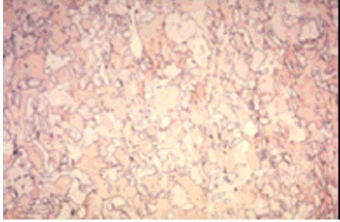
Şekil 2.19 Bakır-nikel alaşımlarının mikro yapıları Tavlanmış: %86,5 Cu, %9-11 Ni, %1-1,8 Fe, %1 Zn, %1 Mn
