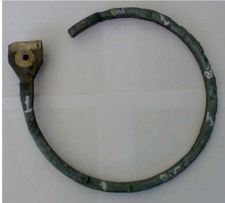
Şekil 6.1 Alaşımsız AISI 1040 çeliğinin spiral kalıpta dökülmüş hali Döküm sıcaklığı: 1600°C, Akıcılık: 68 cm
