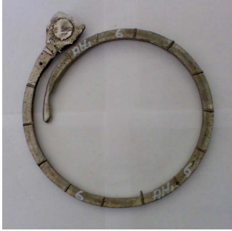
Şekil 6.6 %5 Cr ilaveli alaşımsız AISI 1040 çeliğinin spiral kalıpta dökülmüş hali Döküm sıcaklığı: 1600°C, Akıcılık: 84 cm
