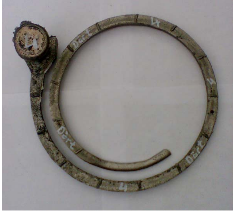
Şekil 6.4 %9 Cr, %9 Ni ilaveli alaşımsız AISI 1040 çeliğinin spiral kalıpta dökülmüş hali Döküm sıcaklığı: 1600°C, Akıcılık: 98 cm
