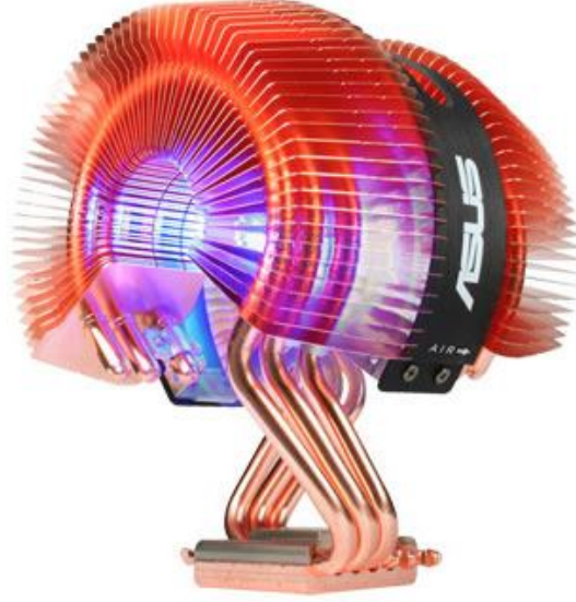
Şekil 1.8 6 ısı borulu, kondenser yüzeyi çok sayıdaki kanatlarla genişletilmiş bir CPU soğutucu.
