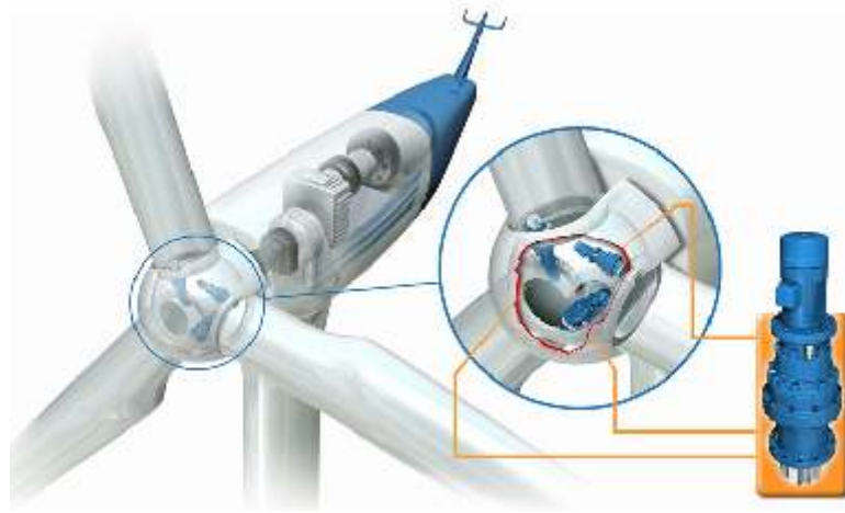
Şekil 8.5 Pitch Mekanizması (Bortolani, L., 2005)
