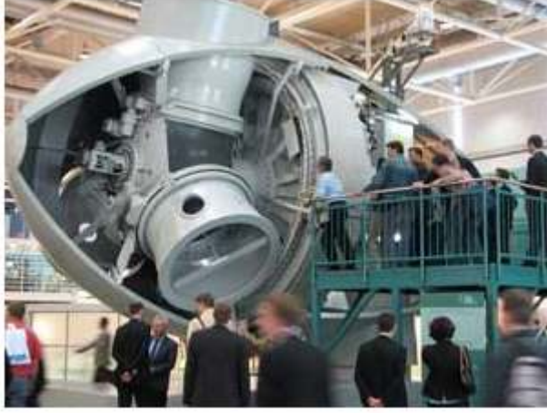
Şekil 8.2 Modern bir Rotor göbeğinin iç yapısı (Enercon,2007)
