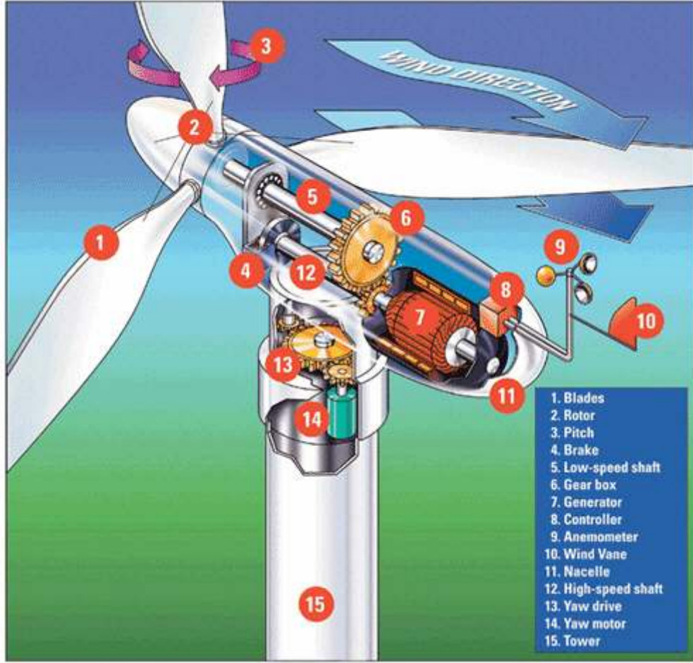
Şekil 8.1 Rüzgar türbini bileşenleri (Anonim, 2008-f)
