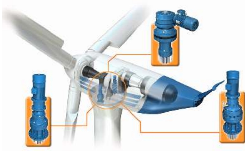
Şekil 8.8 Yaw Mekanizması (Bortolani, L., 2005)
