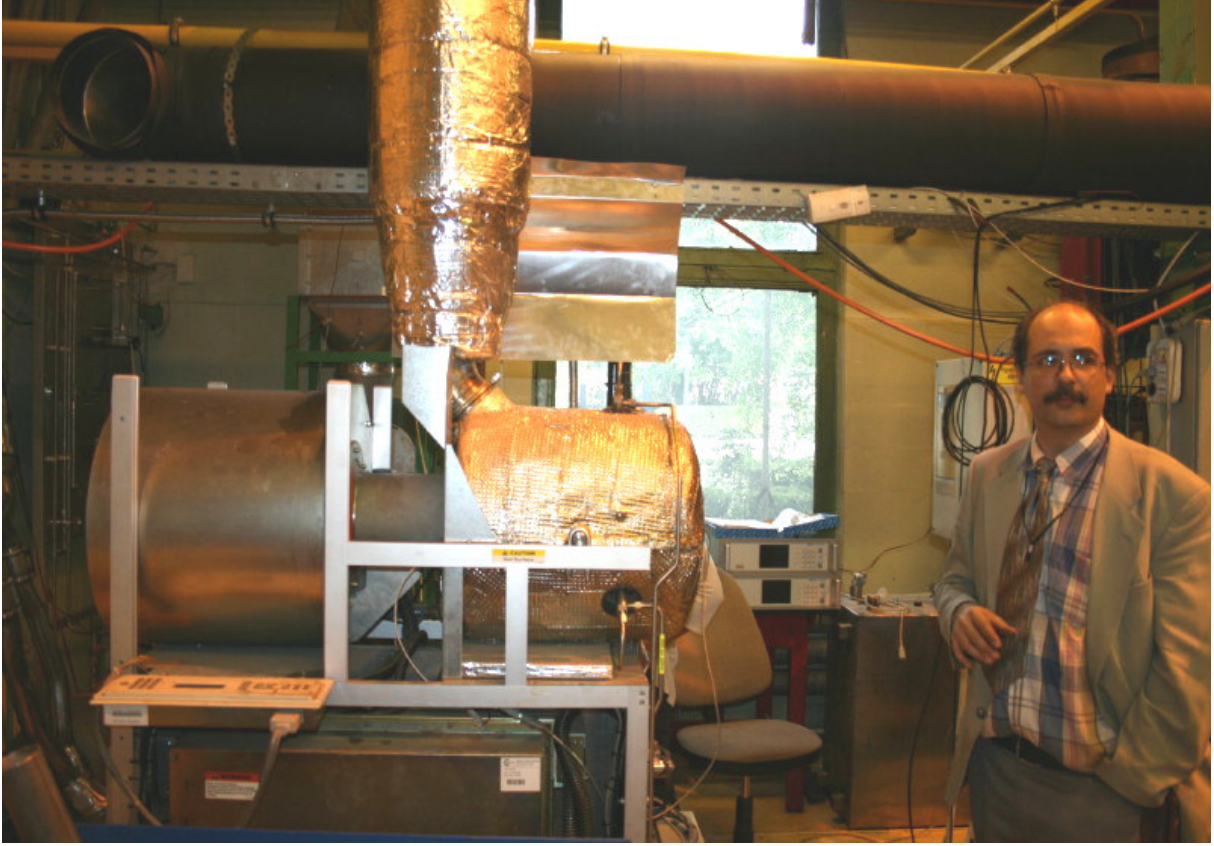
Şekil 3.2 Capstone C30 mikrotürbini için biyo-yakıt deney düzeneği (BME üniversitesi, Jendrassik Isı Lab., Macaristan)
