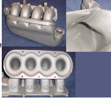
Şekil 5.6 Mercedes üstten beslemeli manifold dizaynı
