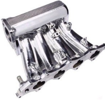
Şekil 5.5 Honda yandan beslemeli manifold dizaynı
