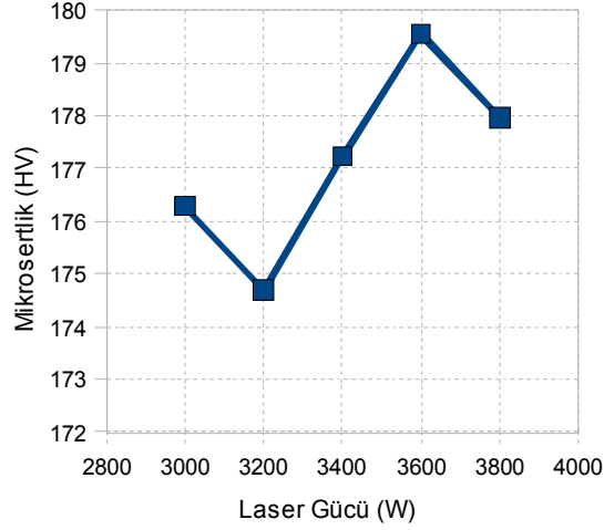
Şekil 4.61. 316 kalite paslanmaz çelik malzemede farklı güçlerdeki sertlik ölçümleri
