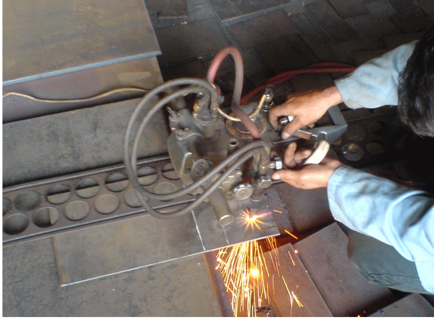
Şekil 2.23. Deneysel çalışmanın yapıldığı oksijen ile kesme makinesi
