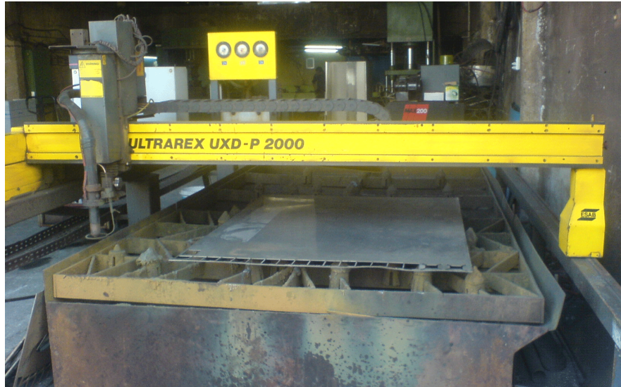
Şekil 3.28. Plazma ile kesme de kullanılan CNC kontrollü tezgah Ultrarex UXD-P
