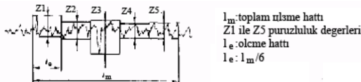
Şekil 2.20. Pürüzlülük ölçümü (Anık vd., 1996).
