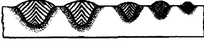
Şekil 7.6 Kaynak Hızının Dikişin Formu Üzerindeki Etkisi (Şematik)
