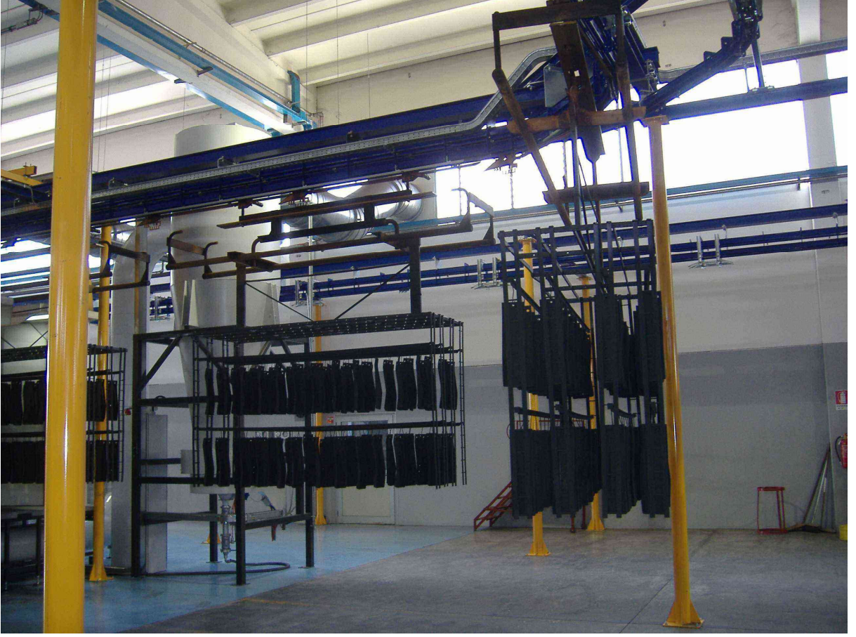
Şekil 2.7 Kaplanacak iş parçası örnek askı grubu
