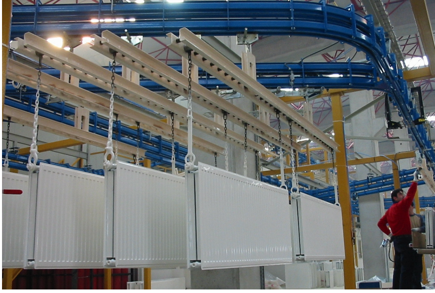
Şekil 4.2 Power+free tip Konveyör Uygulaması
