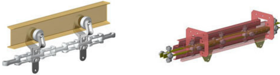
Şekil 4.1 Webb ve Kardan tip Konveyör zinciri
