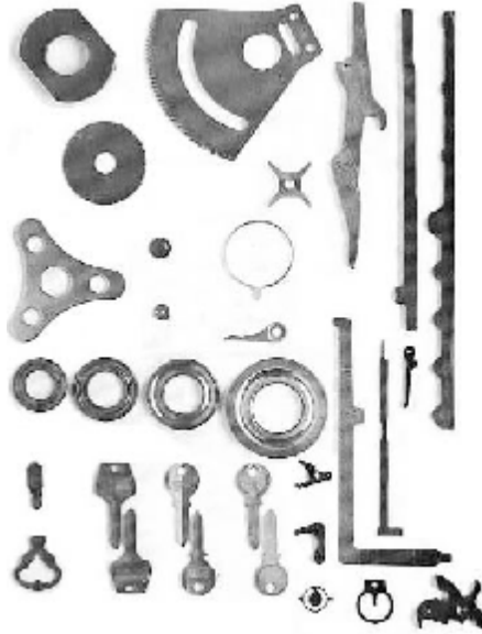
Şekil 6.3: Bu örneklerde hassas kesimin ne kadar esnek olduğunu bir kez daha görüyoruz. Küçük ve nazik elektronik parçalarda bu yöntemlerle üretilebilir.
