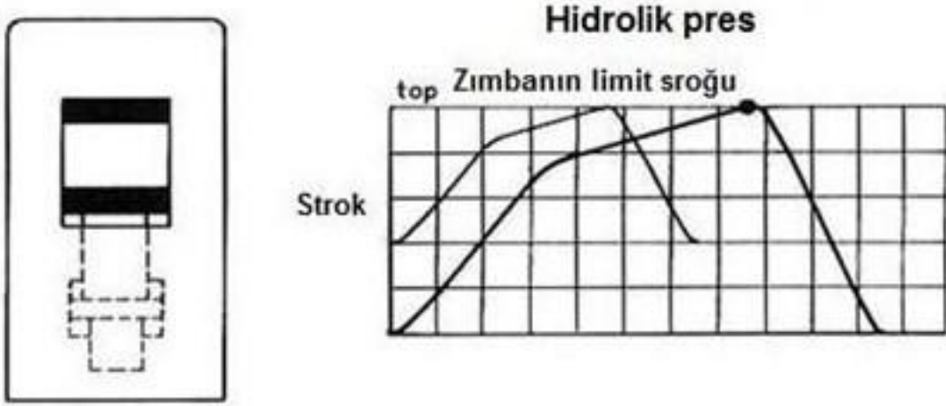
Şekil 4.23: Hidrolik preslerin hız karşılaştırılması (Partech).
