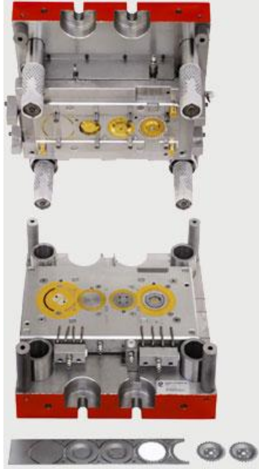
Şekil 4.15: Hassas kesme ve şekillendirmenin bir arada yapıldığı takıma örnek (Partechfineblankig).
