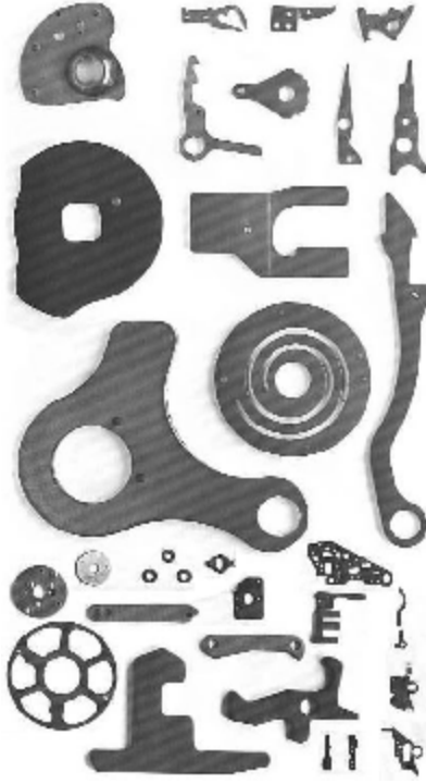
Şekil 6.2: Hassas kesmeyle yapılmış parçalar. Buradaki detaylarda hassas kesimin nasıl bir düzlük sağladığını görmekteyiz.
