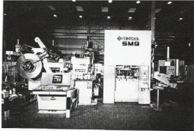
Şekil 4.26: Minimum alana yerleştirilmiş bir hidrolik hassas kesme presi ve ek üniteleri (Feintool, 2001)
