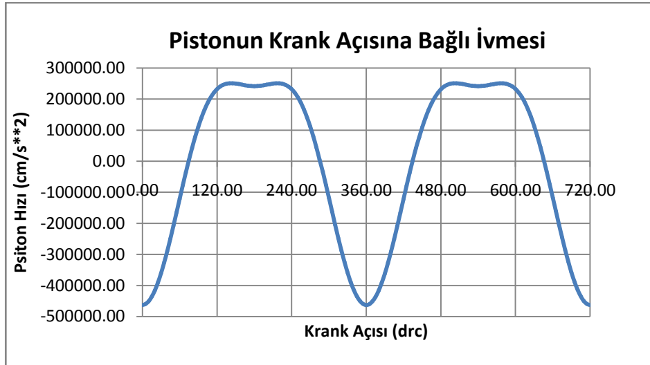
GRAFİK 3 : 2250 devir/dakikada piston ivmesinin krank mili açısına bağlı değişimi.
