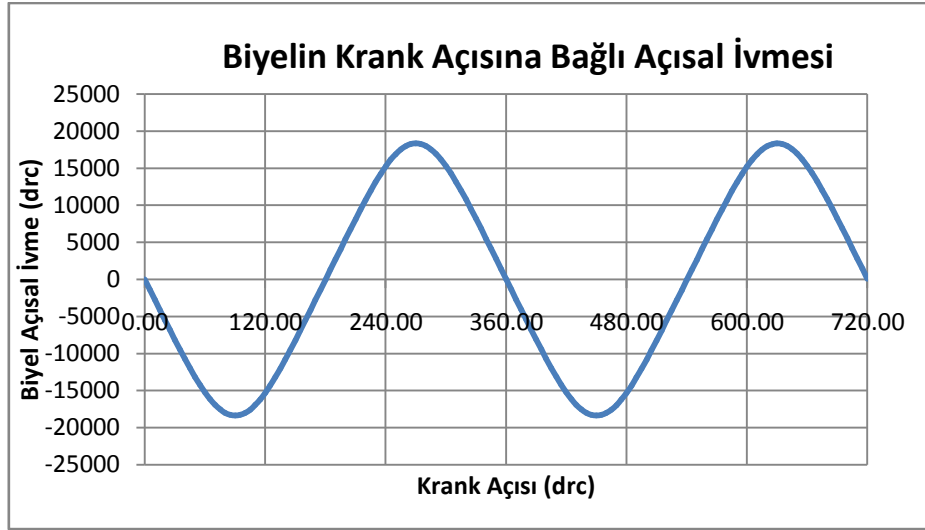
GRAFİK 6 : Biyel açısall ivmesinin krank mili açısına bağılı değişimi.
