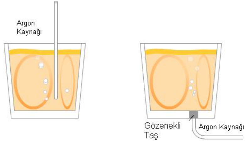
Şekil 2.13 Potaya asal gaz üflenmesi (The AISE,2001)
