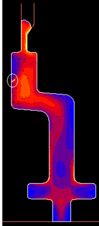
Şekil 5.31 Prosesin sonunda parçada oluşan çatlak görünümü
