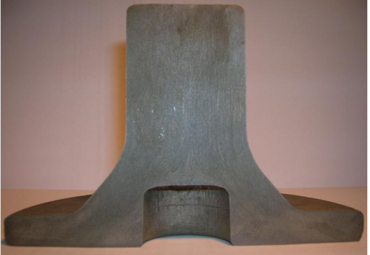
Şekil 5.15 Prosesin sonunda tam bir kalıp dolumu
