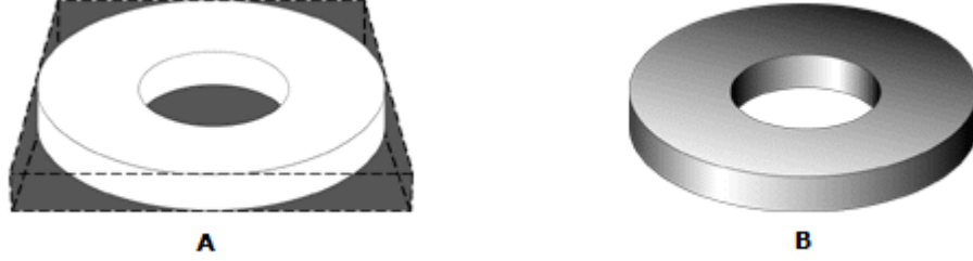
Şekil 1.32 Talaşlı işlem ile oluşturulan parçadaki malzeme kaybı ( www.scotforge.com )
