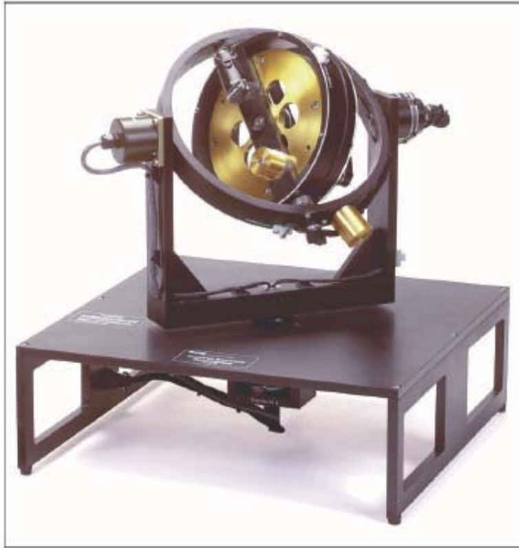
Şekil 3.14 Üç serbestlik dereceli jiroskop örneği
