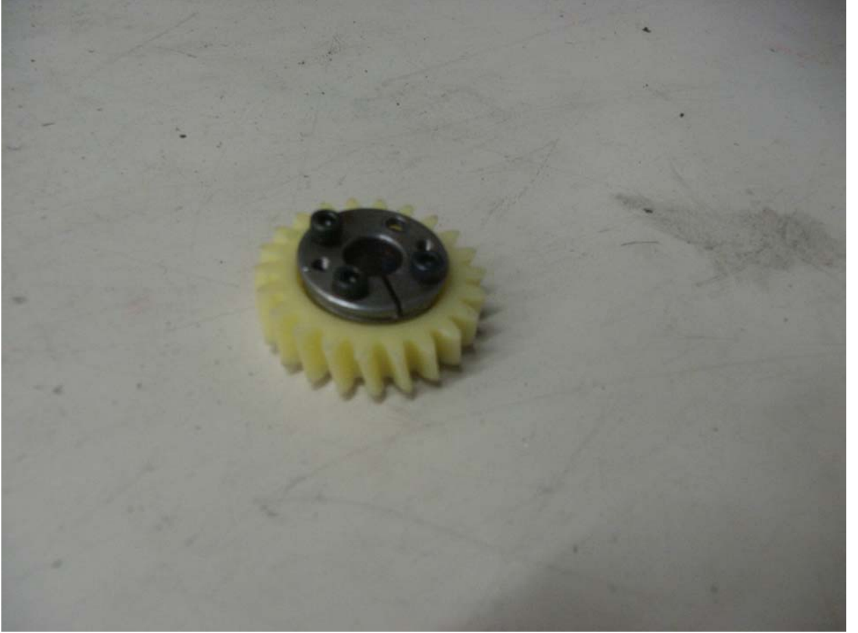
Şekil 6.2 Konik Kavramalı Helisel Dişliçark
