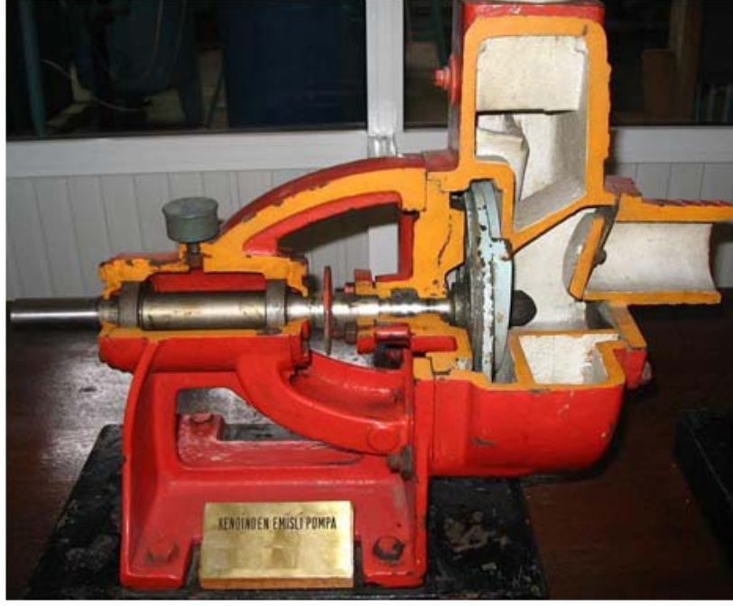
Şekil 5.74 Kendinden emişli santrifüj pompa
