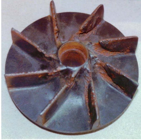
Şekil 4.7 Kavitasyona uğramış çark resmi
