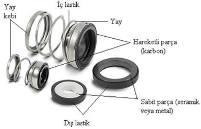
Şekil 3.46 Mekanik salmastra elemanları
