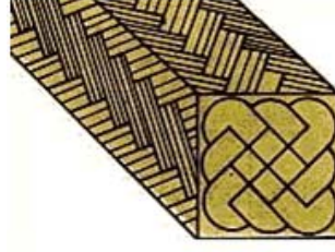
Şekil 3.40 Salmastraların örgü yapısı
