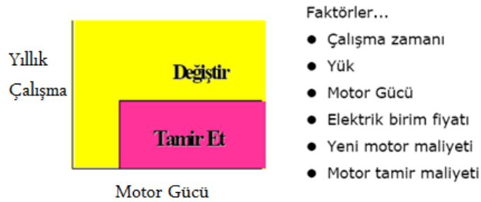
Şekil 5.58 Motor gücü ve yıllık çalışma saatine bağlı olarak motorun değiştirilmesi veya tamir edilmesine karar verilmesi
