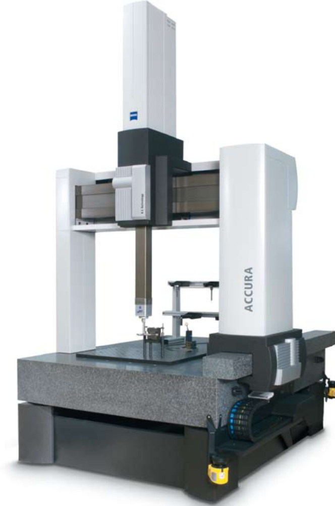
Şekil 6.1 Dairesellik ölçümü için kullanılan dairesellik sapmasını kontrol eden CMM cihazı
