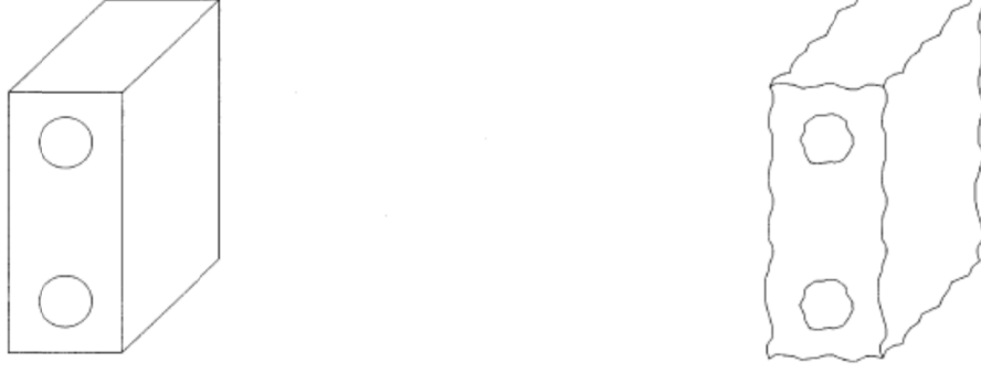
Şekil 2.6 Nominal yüzey / gerçek yüzey (Durakbaşa vd., 2001)
