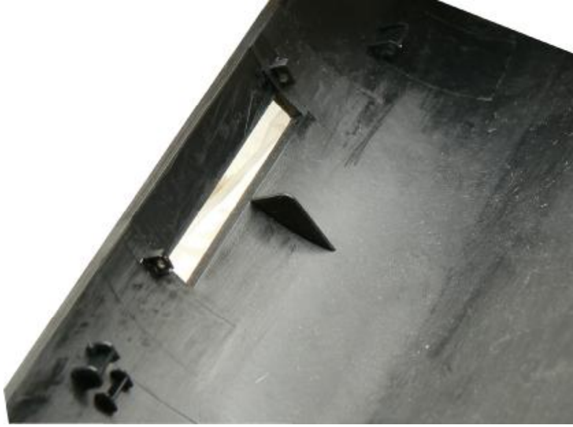
Şekil 16.37. Çöküntüyü meydana getiren feder gösterilmiştir.
