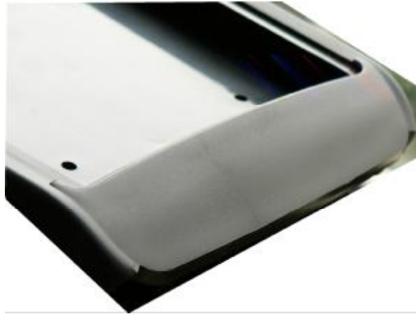
Şekil 16.48. Erkek çelikte yapılan kaynaktan (malzeme ilavesi-et inceltmesi) sonra kaynak çizgisinin yerinde herhangi bir değişiklik olmamıştır fakat kaynak çizgisinin etkisinin azaldığı
