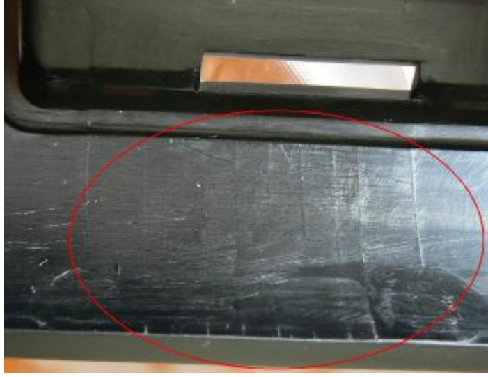
Şekil 16.30. Kaynak çizgisinin etkisini azaltmak için erkek çeliğe uygulanmış lokma izleri gösterilmiştir.
