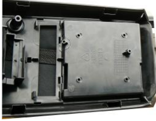
Şekil 16.46. Parçanın görünmeyen (kozmetik olmayan) alt kısmı gösterilmiştir.
