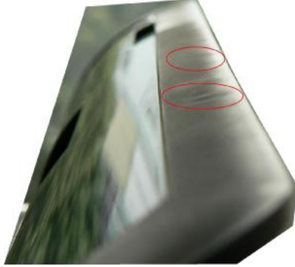
Şekil 16.39. Yapılan enjeksiyon baskısında meydana gelen çöküntüler gösterilmiştir.
