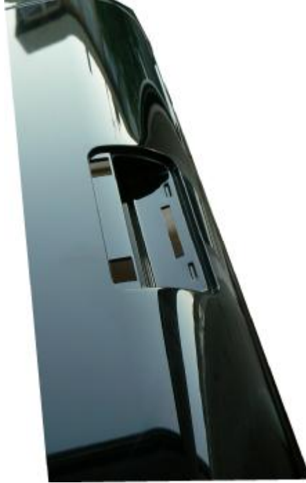
Şekil 16.31. Erkek çeliğin lokmalara ayrılmasından sonraki durum gösterilmiştir. Kaynak çizgileri ortadan kaldırılmıştır.
