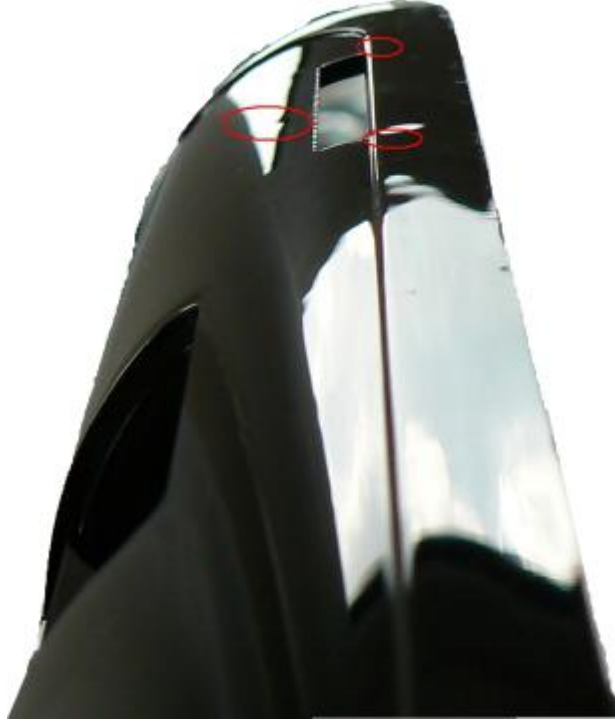
Şekil 16.36. Yapılan enjeksiyon baskısında meydana gelen çöküntüler gösterilmiştir.
