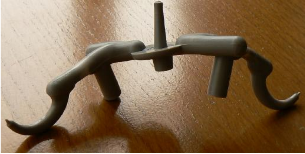
Şekil 16.51. Parçanın muz yolluğu gösterilmiştir.
