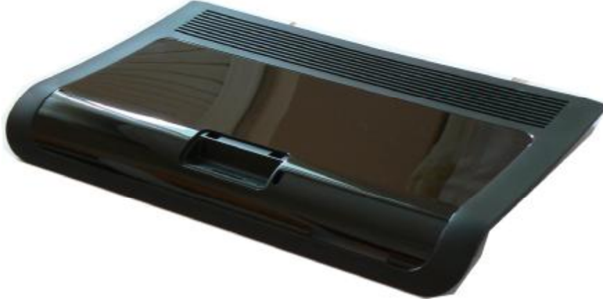
Şekil 16.42. Yüzey işlemleri yapıldıktan sonra enjeksiyon baskısı gösterilmiştir. Resimde mat olarak görünen yüzeye 3 mikron derinliğinde yüzey kumlama işlemi yapılmıştır.
