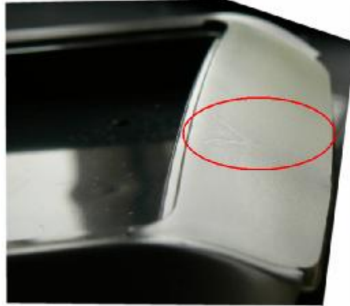
Şekil 16.45. Parçada oluşan kaynak çizgisi gösterilmiştir.
