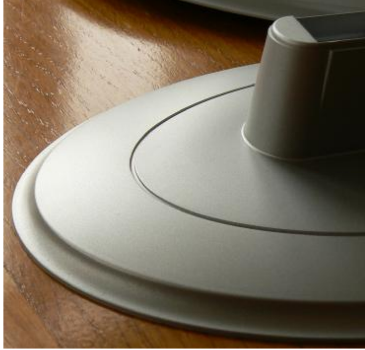
Şekil 16.52. Parçanın üst yüzeyinin hare oluşumunu gizlemek üzere boyanmış hali gösterilmiştir.
