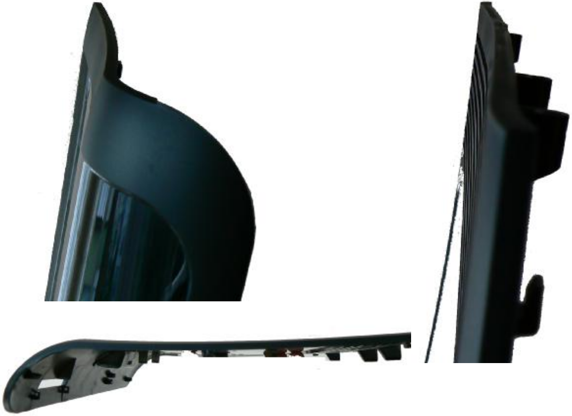
Şekil 16.43 Yapılan enjeksiyon baskısında meydana gelen arpılma gösterilmiştir.
