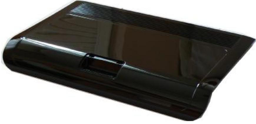
Şekil 16.41. Yüzey işlemlerinin yapılmadan önceki enjeksiyon baskısı gösterilmiştir. Yüzey parlatılmıştır.
