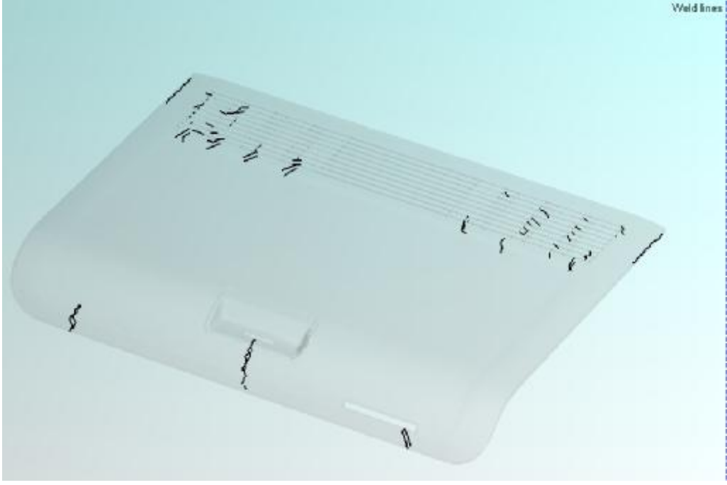
Şekil 16.16. Kaynak çizgilerinin oluşabileceği bölgeler gösterilmiştir.
