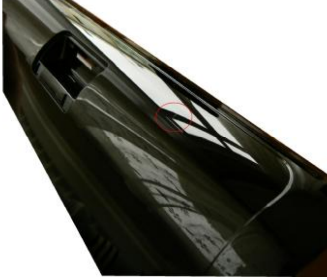
Şekil 16.32 Yapılan enjeksiyon baskısında meydana gelen hava boşluğu gösterilmiştir.
