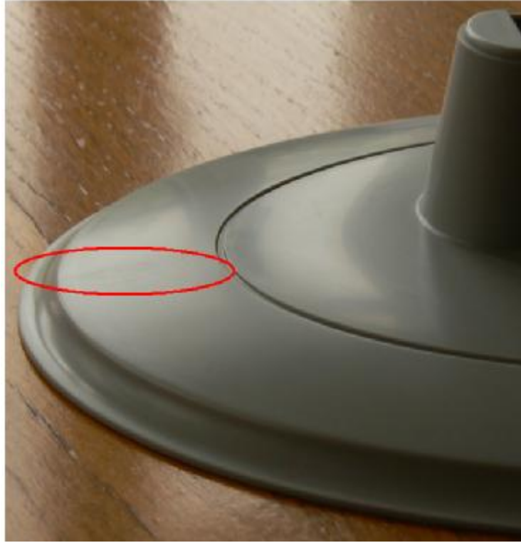
Şekil 16.49. Parçanın görünür yüzeyindeki hare oluşumu gösterilmiştir.
