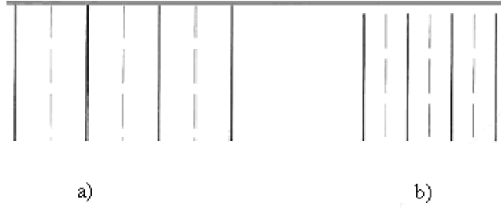
Şekil 14.41. Likit kristaller için moleküler zincir gösterilmiştir. a) Sıvı b) Katı
